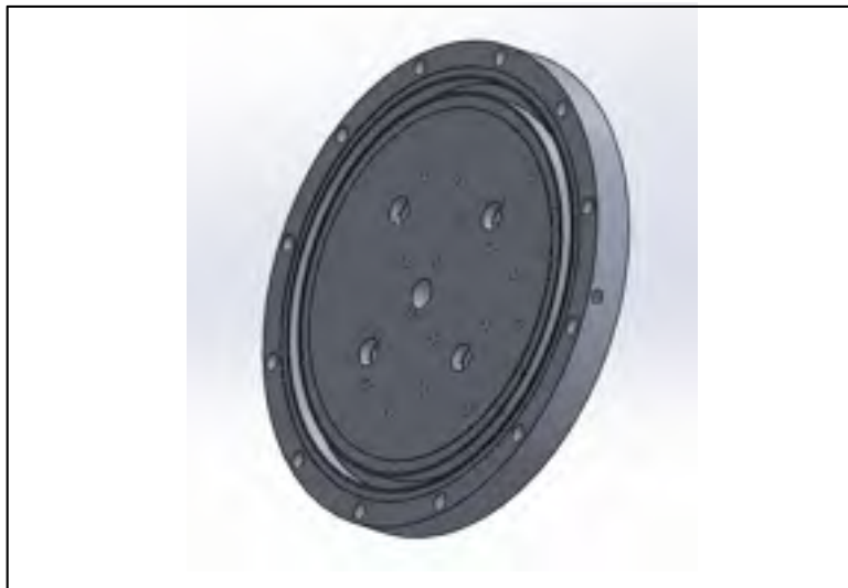
Figure 4.8 Partie supérieure du four à miroir
