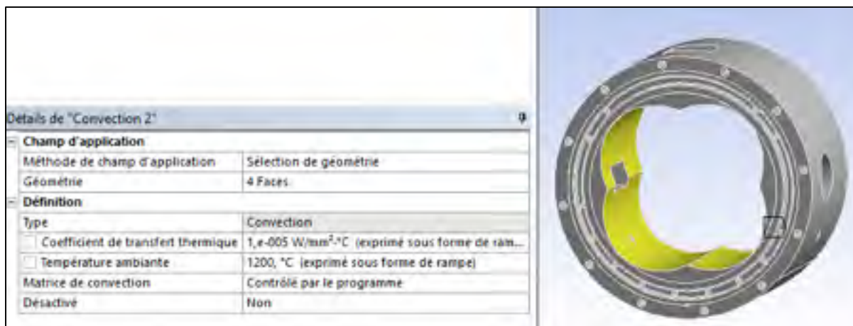
Figure 4.13 Caractéristiques de la convection
