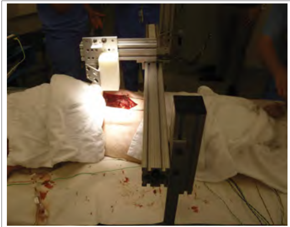
Figure 5.4 Dispositif expérimental permettant de provoquer une blessure par lâcher de poids
