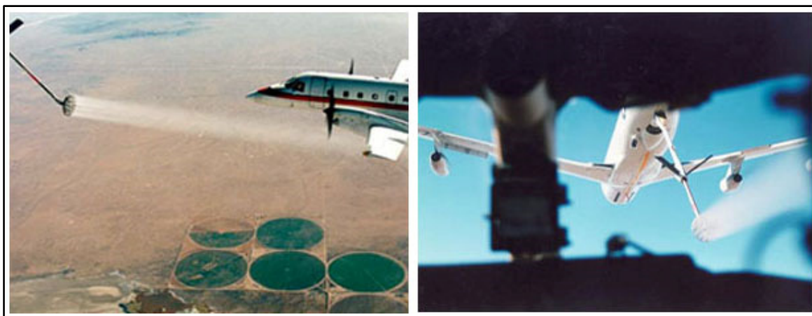
Figure 1.4 Vol d'essai grandeur nature avec buse givrante Tirée de FAA, 2016
