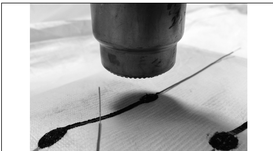
Figure 3-2 : Vulcanisation des capteurs
