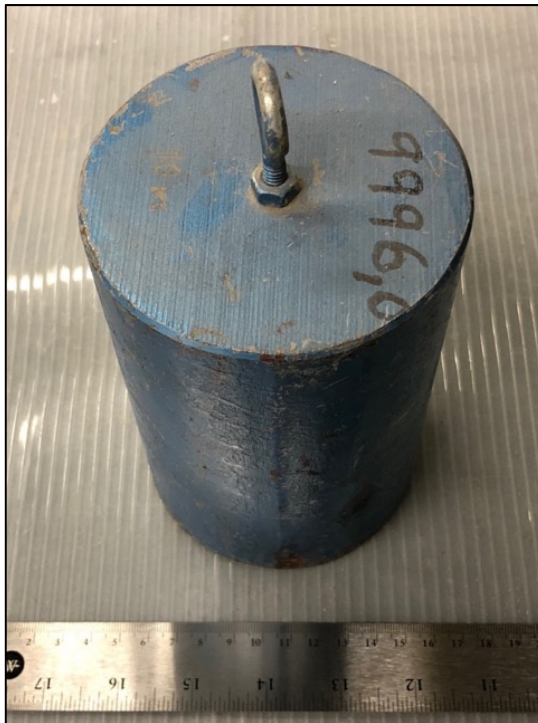
Figure 5.30 Masse de 10 kg pour endommagement
