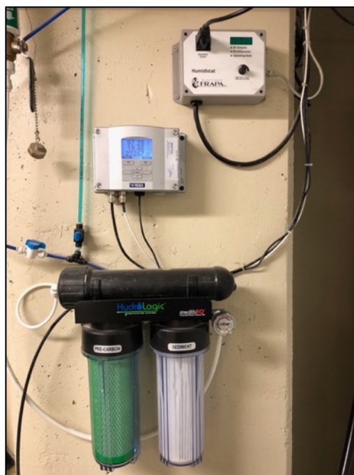
Figure 6.6 Contrôle numérique de la chambre environnementale
