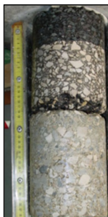
Figure 1.13 Délamination typique entre l'enrobé et les BTC (Buttlar et al., 2018)
