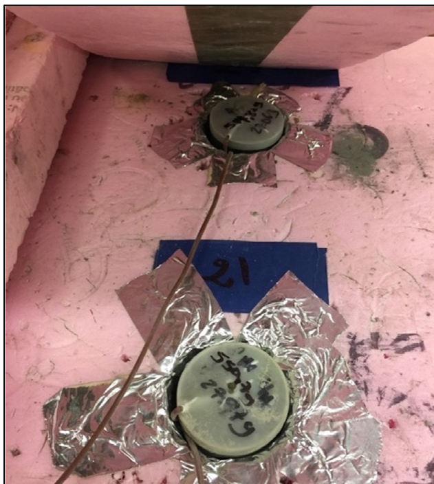
Figure 5.17 Éprouvettes et isolation de l'essai de calorimétrie
