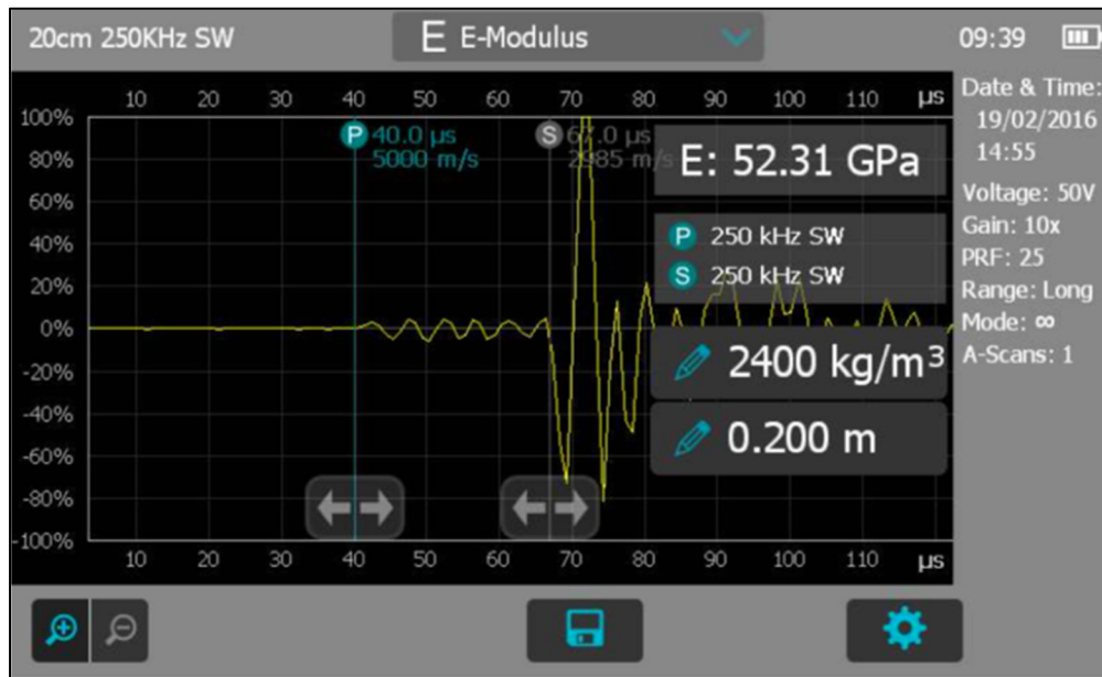
Figure 1.36 Signal mesuré sur un appareil Proceq (Corbett, 2016)
