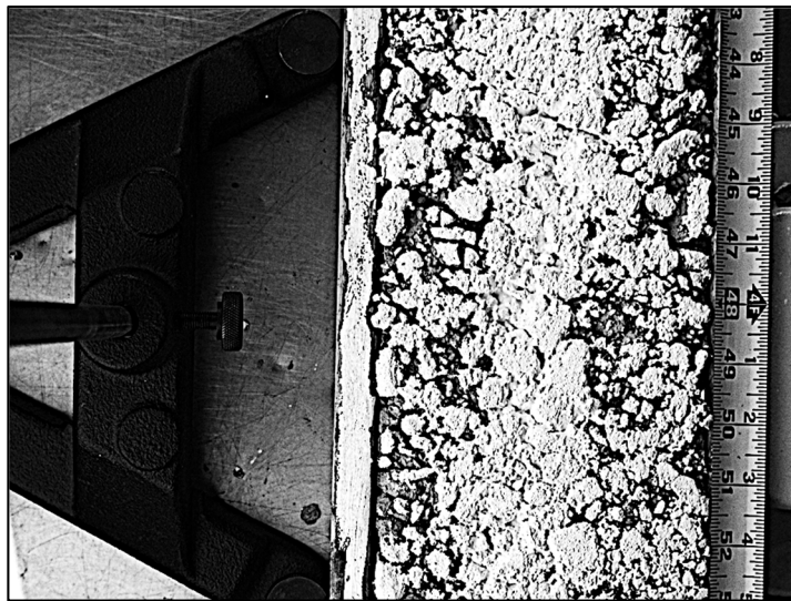
Figure 5.27 Plaque de retrait à 39 jours (image ajustée)
