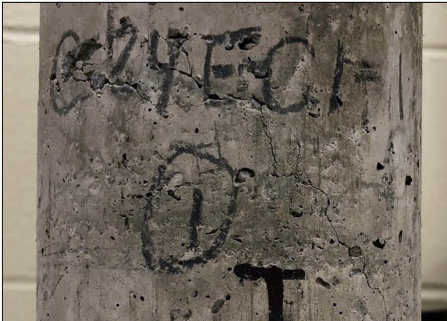
Figure 6.13 Fissuration de l'éprouvette C24EC1-1 après endommagement élevé
