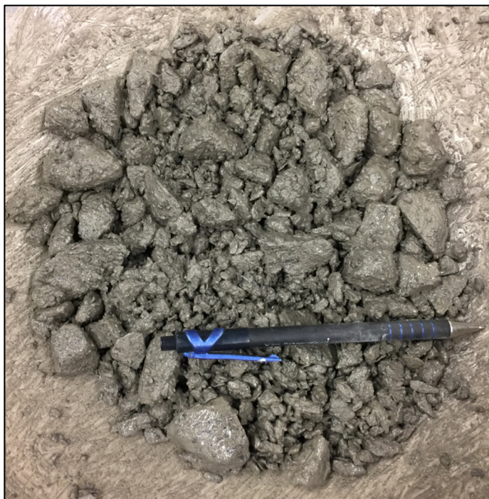
Figure 4.3 BTC à l'état frais avec 5 % de ciment
