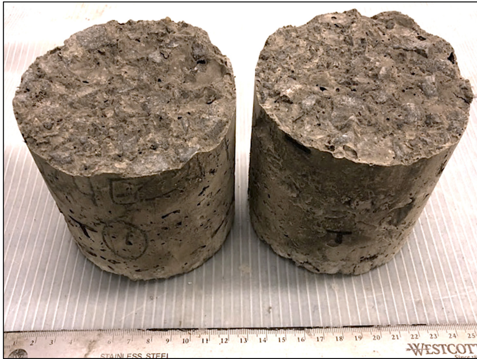
Figure 6.14 Bris de l'éprouvette D24EC4-1 après endommagement élevé
