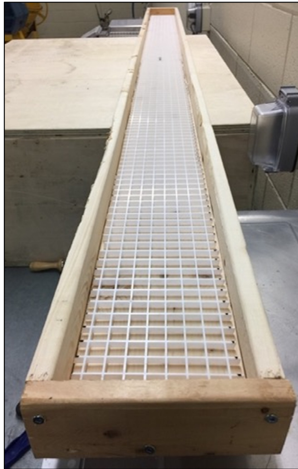
Figure 5.21 Moule pour plaque de retrait empêché
