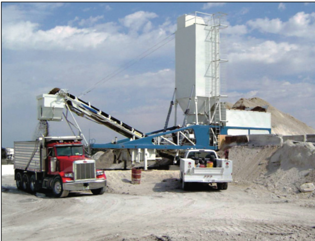
Figure 1.24 Centrale de malaxage mobile de type "Pugmill" (Halsted, Luhr et Adaska, 2006)
