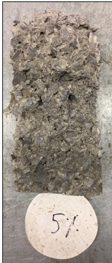
Figure 5.8 Texture interne des échantillons, vibration à la table, 5 %
