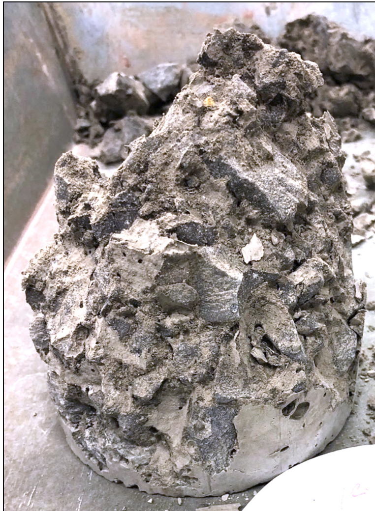
Figure 6.21 Rupture typique à l'interface pâte-granulat à 24 heures de cure
