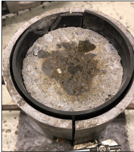
Figure 6.11 Gaine en caoutchouc pour confinement
