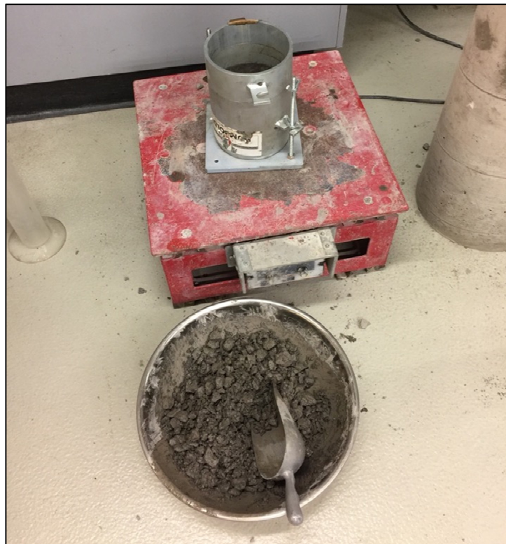
Figure 4.15 Mise en place des moules CBR
