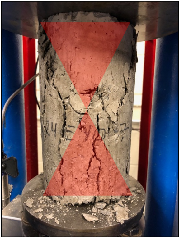
Figure 5.72 Endommagement ultime par compression
