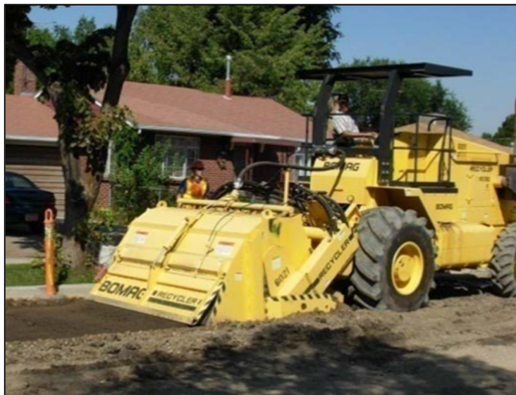
Figure 1.22 Recycleuse de chaussée (Hope, 2011)
