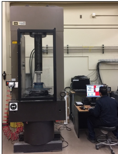
Figure 4.5 Mesure de la résistance en compression et du module mécanique
