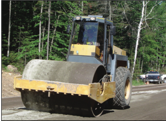
Figure 1.26 Compacteur à cylindre d'acier vibrant (Halsted, Luhr et Adaska, 2006)
