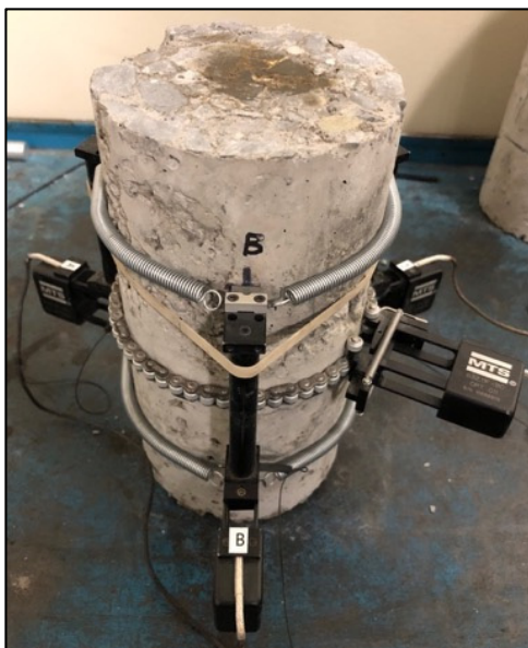
Figure 5.66 Positionnement des extensomètres
