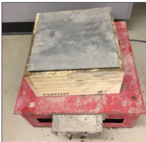
Figure 5.51 Nivellement des bases pour LWD
