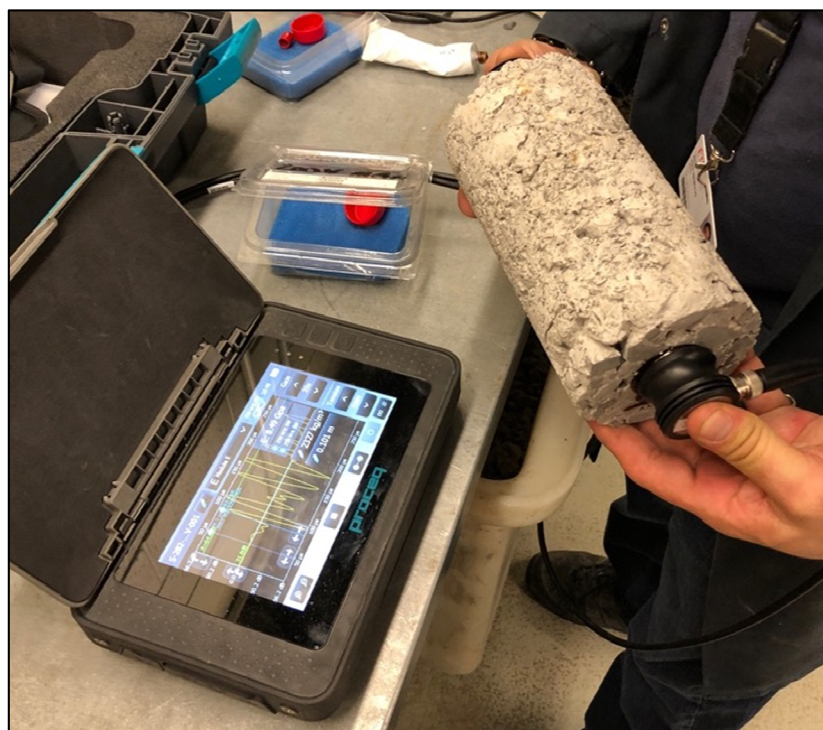
Figure 5.45 Mesure avec appareil Proceq Pundit PL-200
