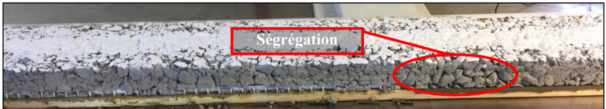
Figure 5.28 Plaque de retrait démoulée
