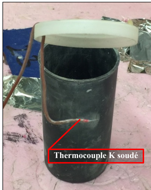
Figure 5.16 Assemblage cylindre calorimétrie
