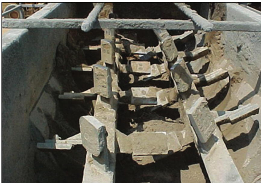
Figure 1.25 Chambre de malaxage d'une centrale (Halsted, Luhr et Adaska, 2006)
