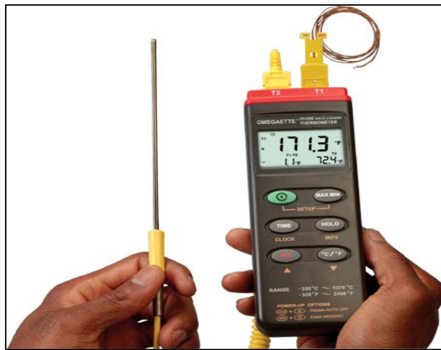
Figure 8.1 Sonde de température avec embout isolé (tirée de http://www.omega.com/pptst/HH305_306.html )
