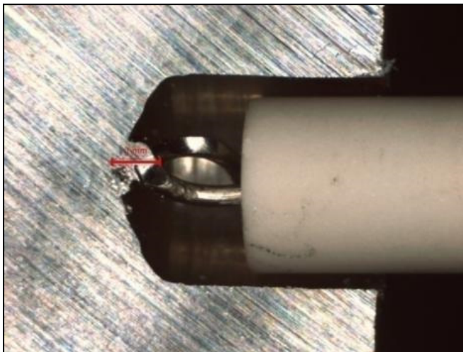
Figure 6.13 Thermocouple soudé au fond du trou d'une plaque
