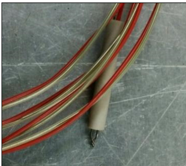
Figure 3.16 Photo d'un thermocouple assemblé (torsadé)
