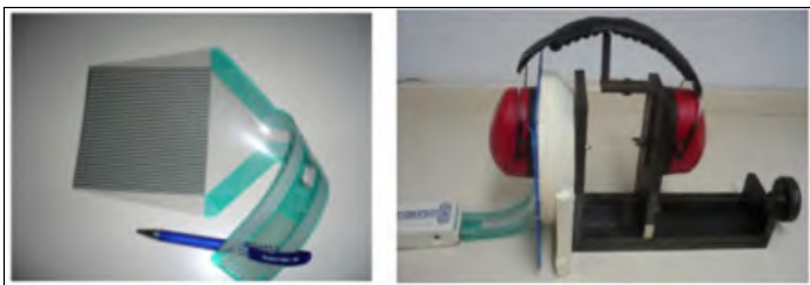
Figure 2.5 Le système Tekscan utilisé pour mesurer la pression exercée par les coussins des casques
