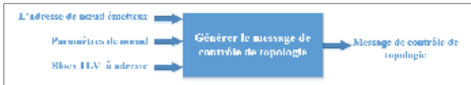
Figure 3.9 La fonction générant le message de contrôle de topologie
