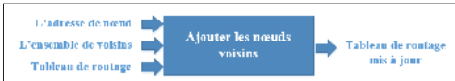
Figure 3.21 La sous-fonction présentant la première étape de l'algorithme de Dijkstra
