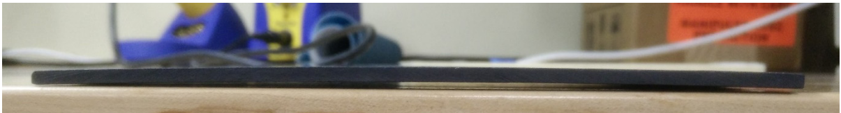
Figure 3.8 : Courbure sur les plaques due aux contraintes thermiques et un empilement non symétrique.
