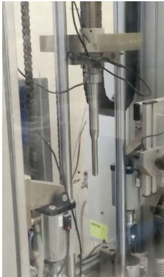
Figure 2.4 : Impacteur de \frac{1}{2} po utilisé pour les impacts DTI
