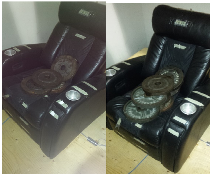
Figure 2.5 : Disposition des plaques d'entraînement sur le fauteuil pour 100 lb et 200 lb
