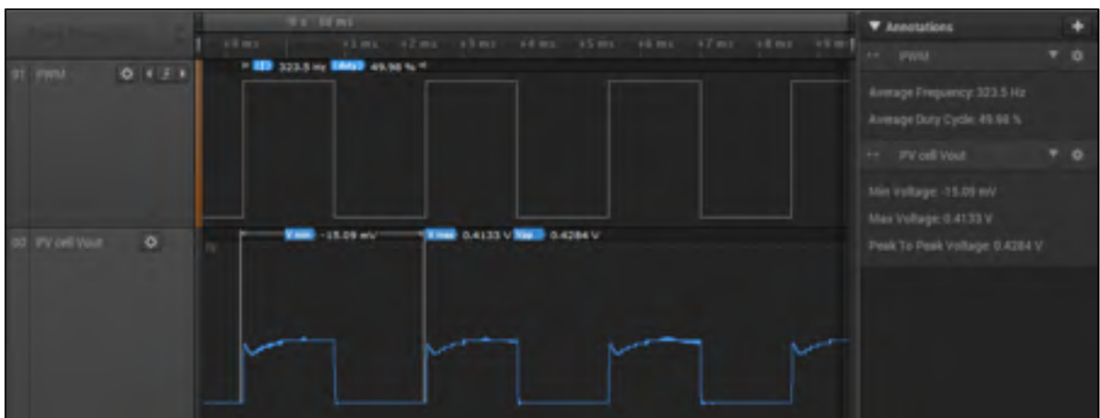
Figure 4.9 Tension de sortie d'une cellule PV avec un cycle de fonctionnement de 50%
