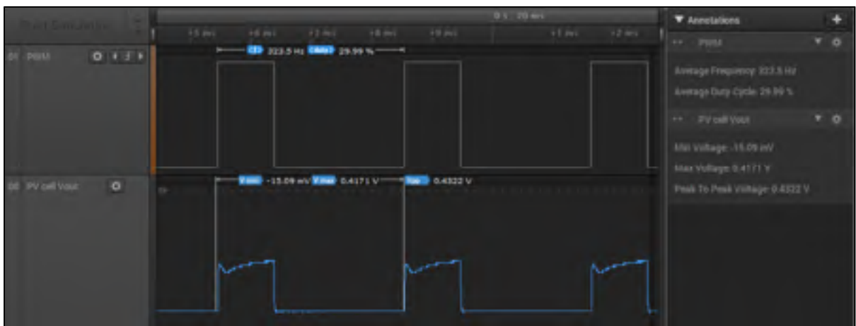
Figure 4.8 Tension de sortie d'une cellule PV avec un cycle de fonctionnement de 30%
