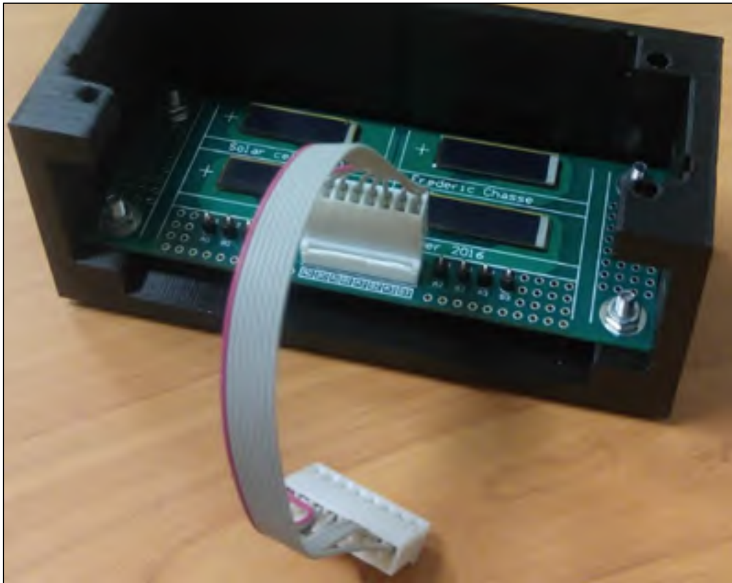
Figure-A VII-4 Photo du PCB assemblé et monté dans son boîtier
