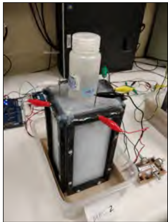
Figure 3.13 Montage d'une PCM
