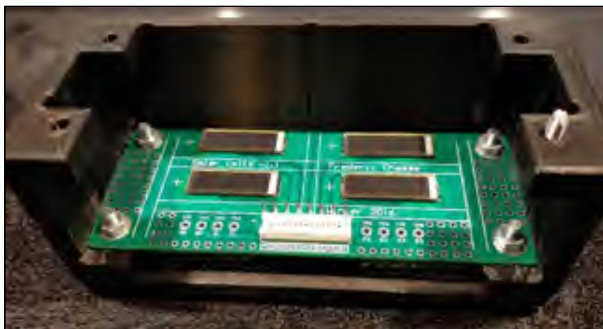
Figure 4.3 PCB de cellules PV encapsulé dans le boîtier
