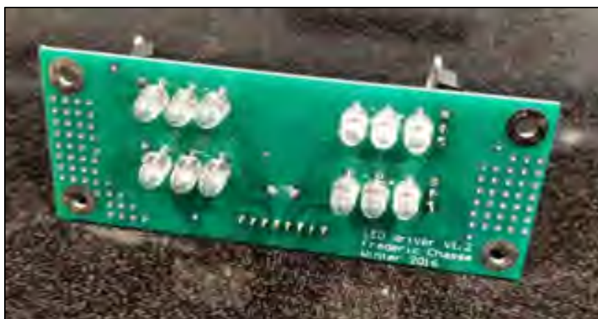
Figure 4.5 Vue du dessous du PCB de DEL du banc d'essai
