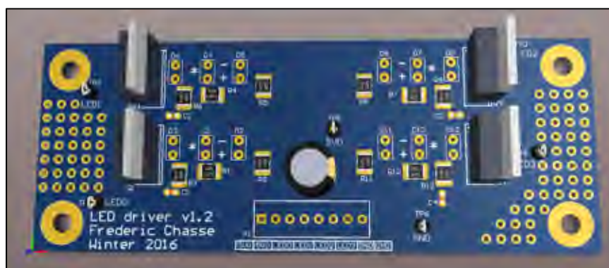
Figure 4.4 Vue 3D du dessus du PCB de DEL
