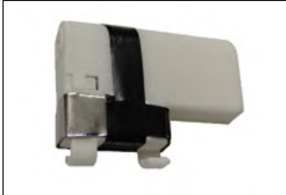
Figure 2.8 Capteur HES avec blindage de mumétal Tirée de Levasseur (2013b p. 30)
