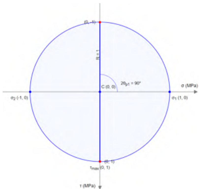
Figure 2.9 Cercle de Mohr durant essais de traction diagonale
