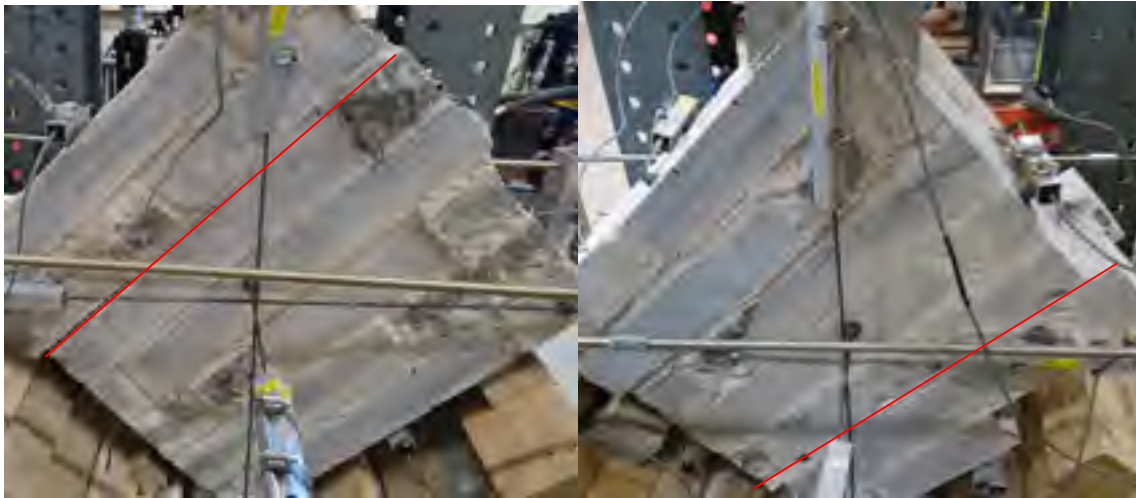
Figure 4.10 Fissuration des spécimens suite aux essais de traction diagonale
