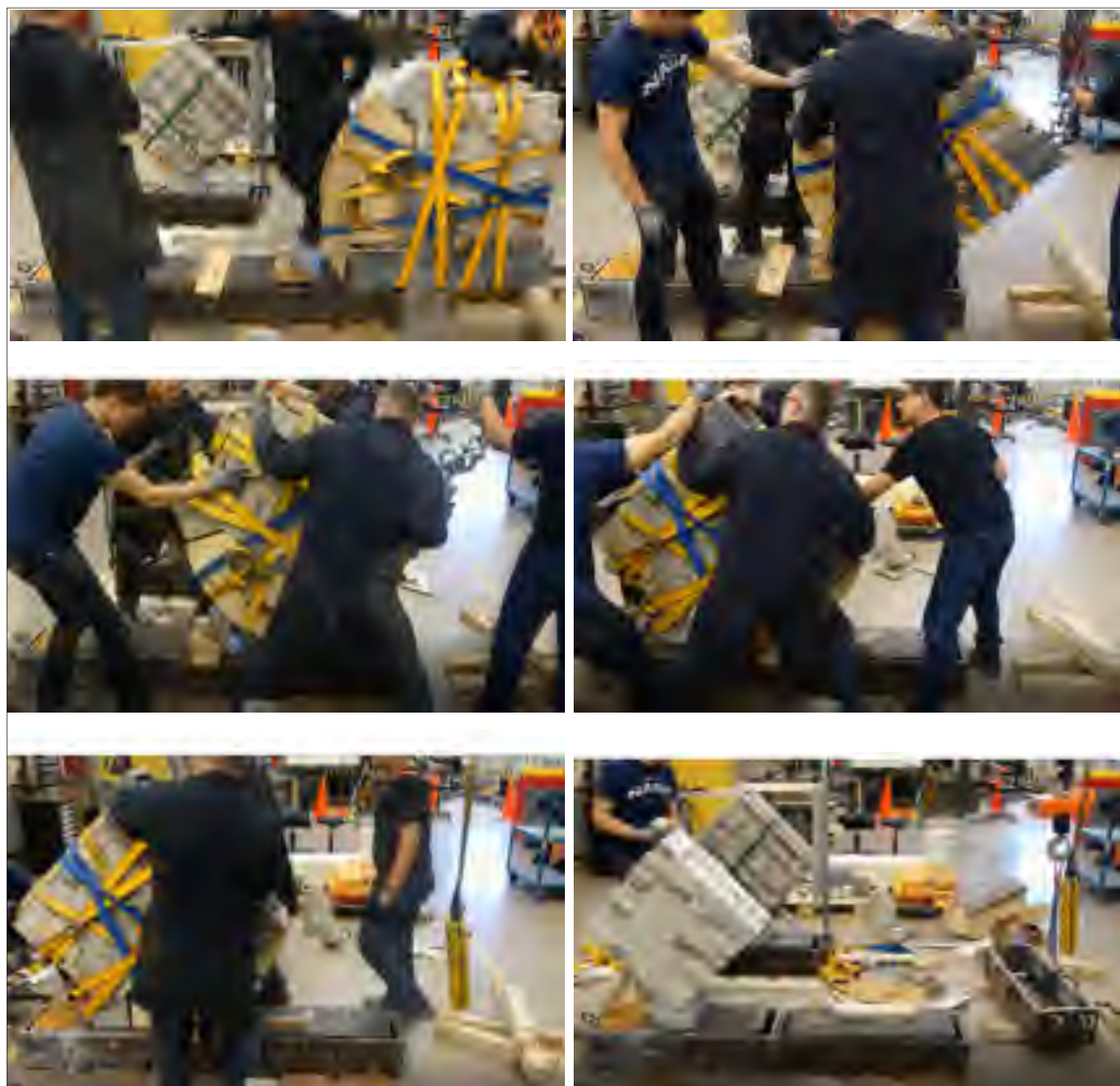
Figure 3.12 Mise en place des spécimens à 45 degrés pour les essais de résistance à la traction diagonale
