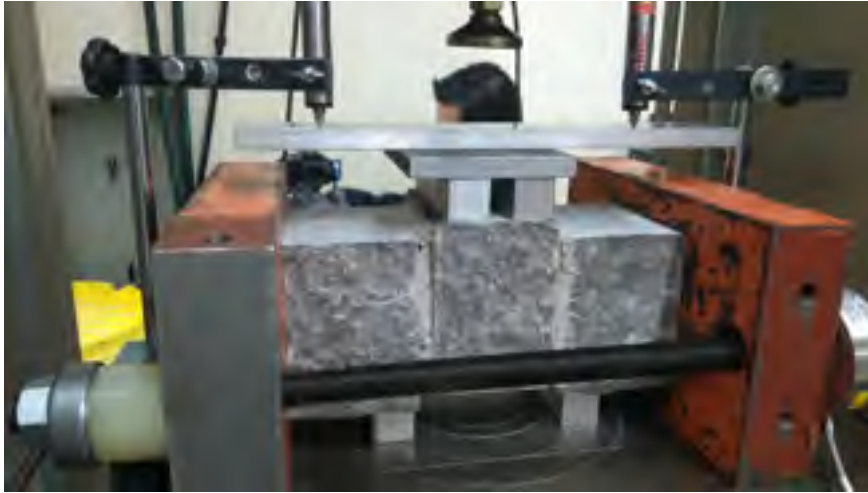
Figure 3.7 Assemblage en MNA pour l'essai de résistance au cisaillement
