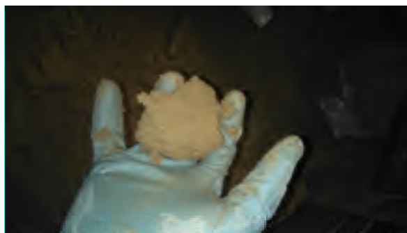
Figure 3.2 Boule de mortier à la consistance souhaitée
