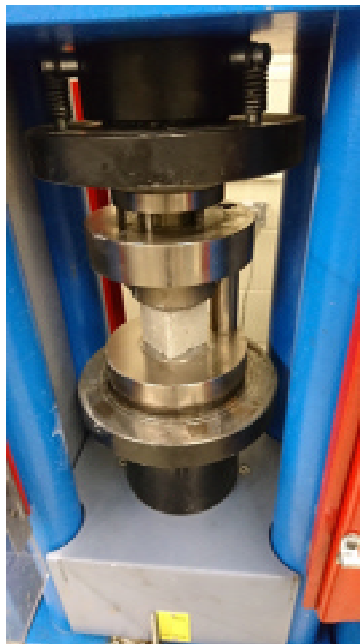
Figure 3.18 Essais de la résistance en compression du mortier
