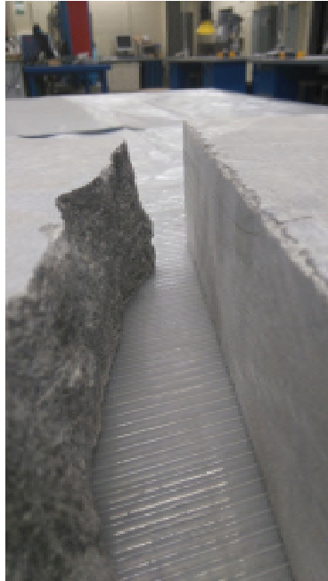
Figure 3.5 Surfaces des pierres : à gauche surface latérale guillotinée /taillée, à droite surface lisse sciée
