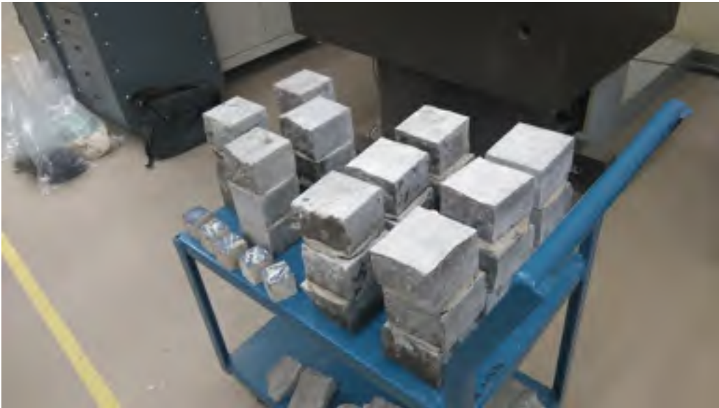
Figure 3.1 Spécimens de mortier et pierres de la phase I
