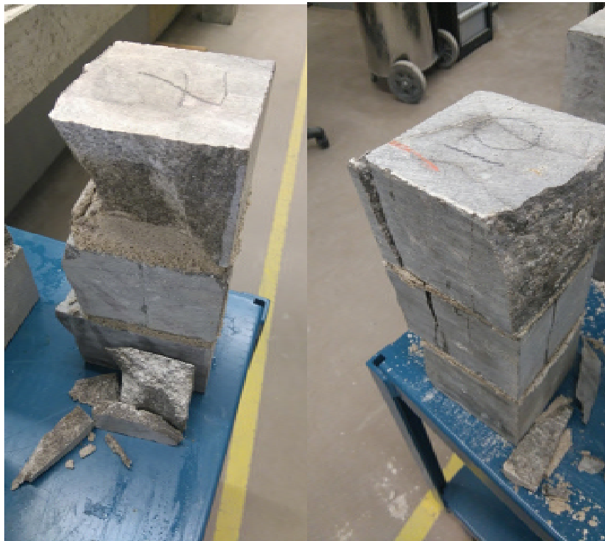
Figure 4.1 Spécimens après essai de compression
