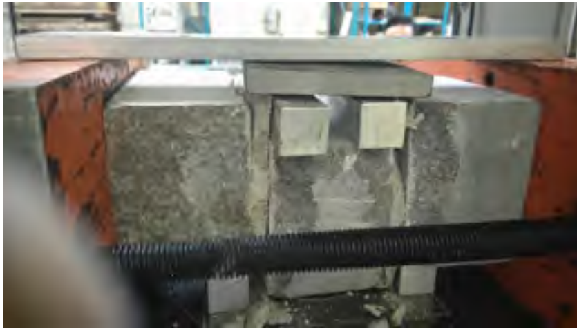
Figure 4.3 Spécimens après rupture à l'essai de cisaillement
