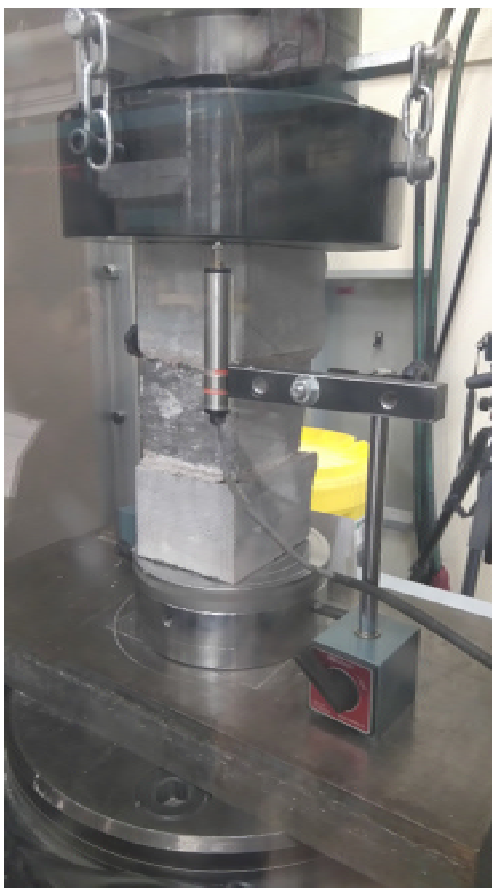
Figure 3.6 Assemblage en MNA pour l'évaluation de la résistance à la compression
