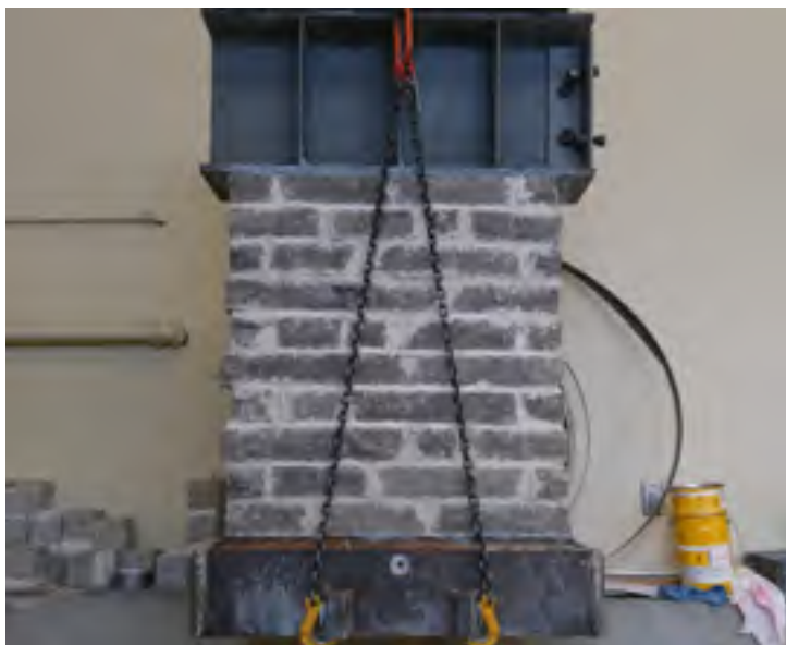
Figure 3.10 Spécimens de la phase II (surface guillotinée)
