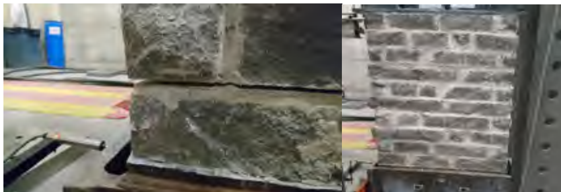
Figure 4.8 Fissuration dans le bas des spécimens durant les essais cycliques
