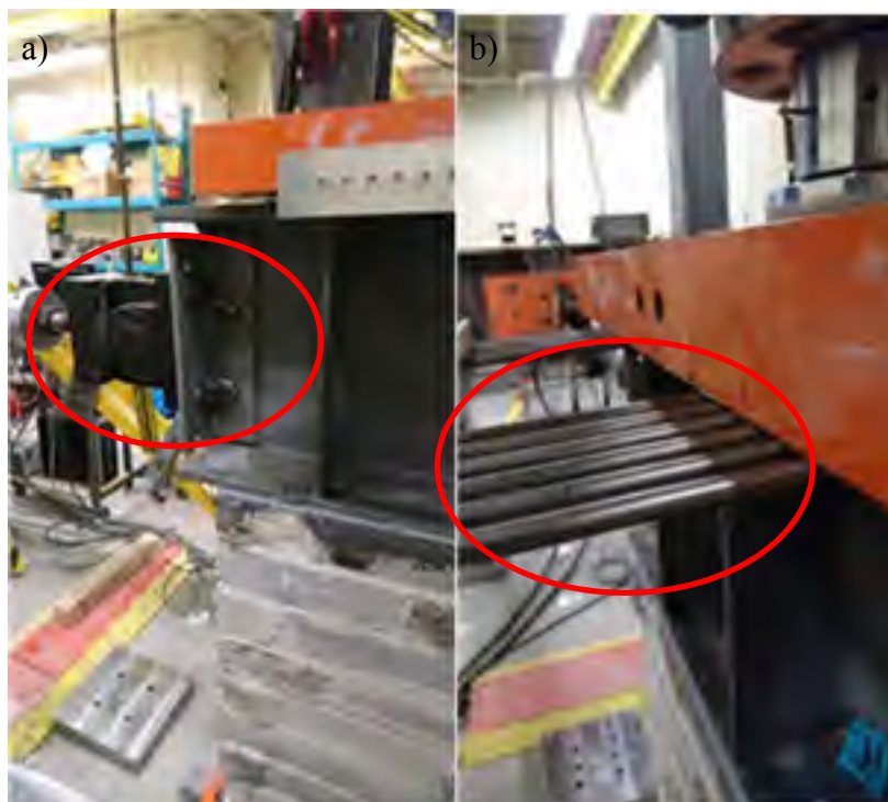
Figure 3.15 a) Connexion du vérin à la poutre du muret et b) Rouleaux réduisant le frottement
