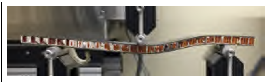
Figure 3.16 Rupture au cisaillement transverse
