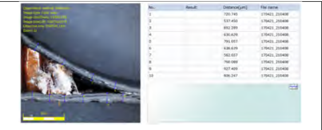
Figure 3.13 Observation microscopique de l’angle de lèvre : découpe à 30 degrés
