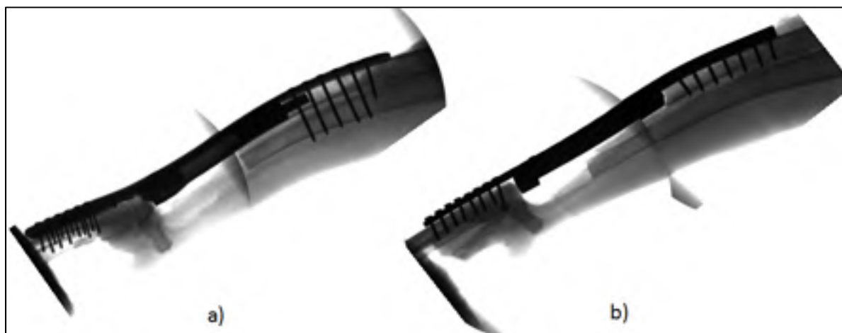
Figure 3.5 : Radiographie post-expérimentale du membre instrumenté d'endoprothèse : a) personnalisée et b) commerciale
