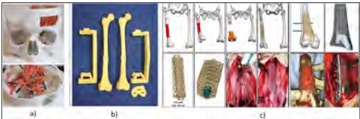
Figure 1.6 : Applications de la fabrication additive en médecine : a) modèle physique pour planification de neurochirurgie, b) guide de coupe pour un fémur, et c) implants en treillis conçus et implantés dans le fémur
