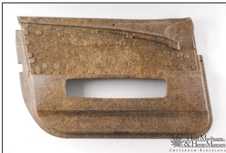
Figure 1.3 Panneau de porte en plastique de chanvre (Tirée de http://hashmuseum.com/fr/la-plante/chanvre-industriel/plastique-de-chanvre )
