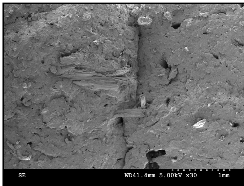
Figure 3.18 Étude microscopique de la surface de rupture d'un échantillon de la F3 de l'essai d'Impact
