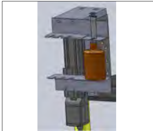
Figure 3.2 Système de remplissage des seringues, assemblage de la seringue et de la bouteille Tirée de Kalafate (2010)
