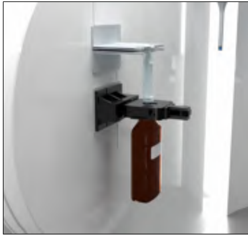
Figure 2.22 Modélisation de l'insertion de la seringue dans la bouteille
