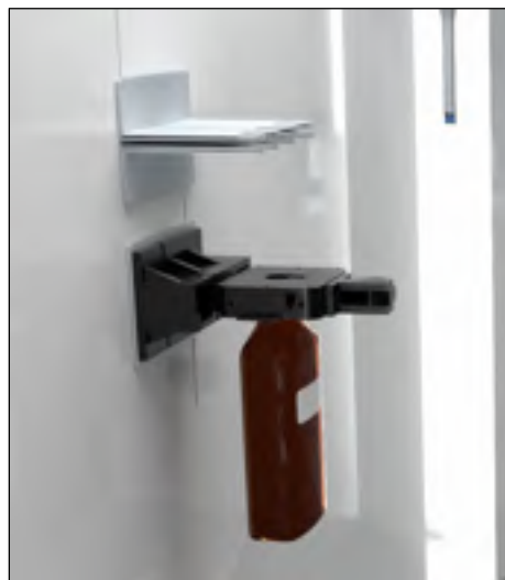
Figure 2.34 Modélisation du positionnement de la bouteille dans la zone de remplissage
