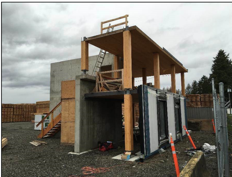
Figure 4.24 Prototype échelle 1 pour les tests d'assemblage Tirée de TOPICs Lab (2016)
