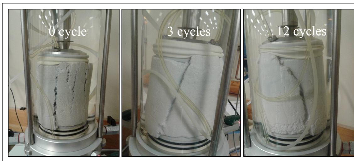
Figure 3-4 Mode de rupture des éprouvettes du premier mélange sable-ciment en fonction du nombre des cycles de gel-dégel
