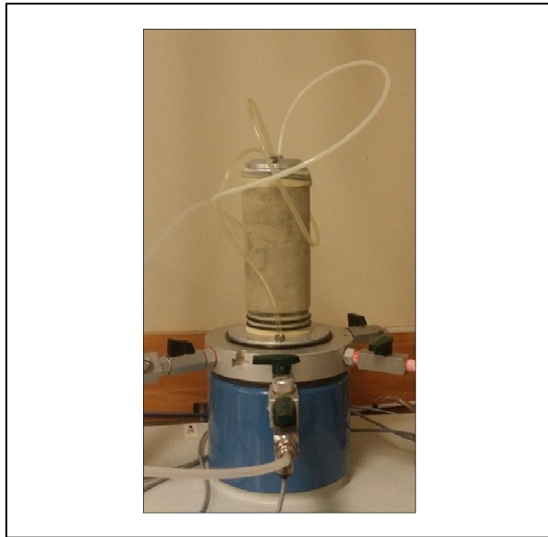
Figure 2-9 Éprouvette placée sur la base de l'appareil triaxial
