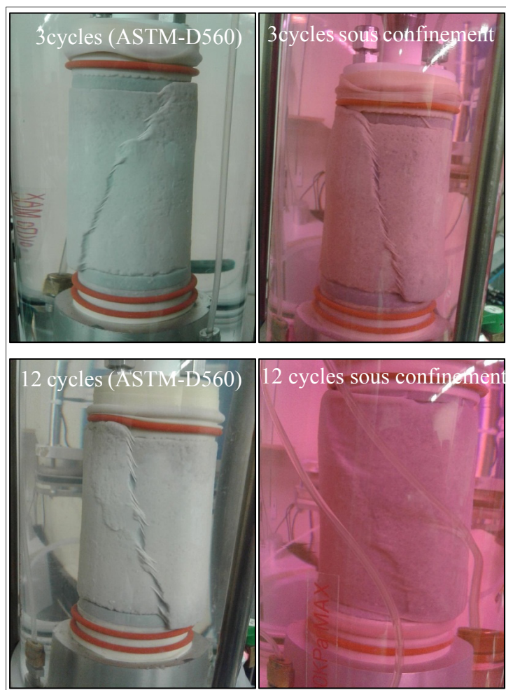
Figure 3-20 Mode de rupture après des cycles de gel-dégel sous une pression de confinement
