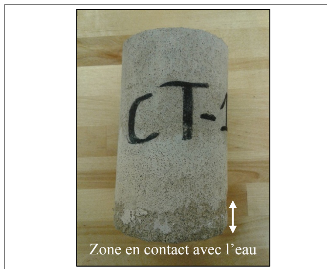
Figure 3-7 Détérioration à la base de spécimen sous l'effet de gel-dégel
