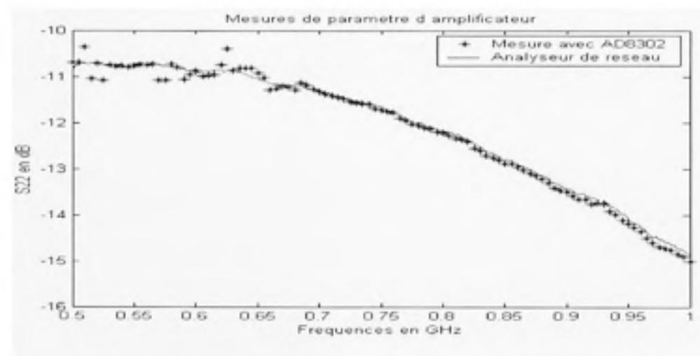
*Figure 3.34 Mesure de paramètres S d'amplificateur (suite).*
