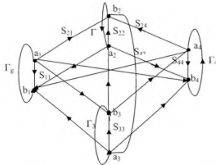
*Figure 3.5 Graphe de fluence du banc de test.*
