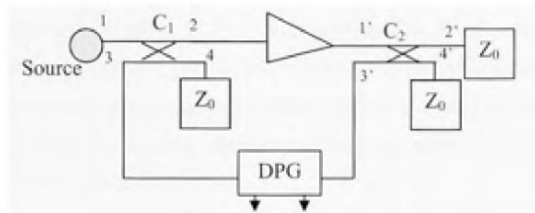
Figure 3.14 Deuxième configuration de mesure de gain.
