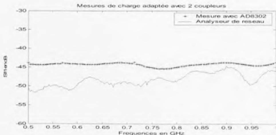
*Figure 3.24* Mesure de charge adaptée avec deux coupleurs.
