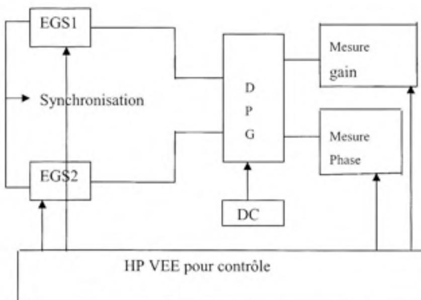
*Figure 2.6 Éléments de caractérisation du DPG.*
