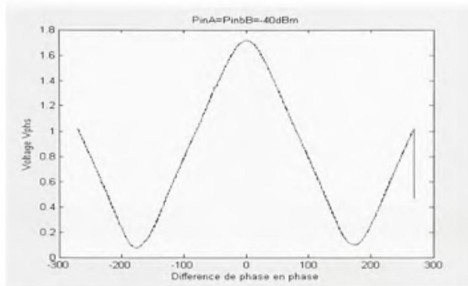
**Figure 2.11 Fonction de transfert en phase.**
