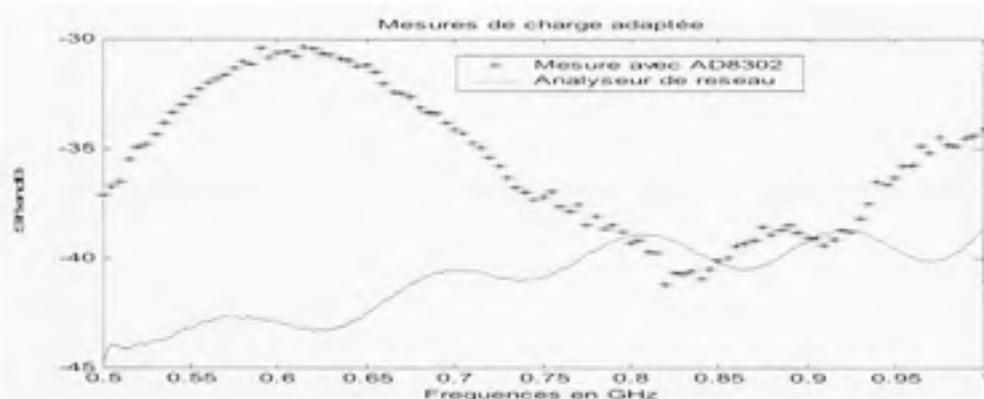
*Figure 3.23* Mesure de charge adaptée avec un coupleur.
