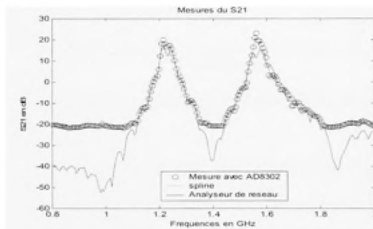
*Figure 3.31 Mesure de S21 pour un filtre sélectif.*
