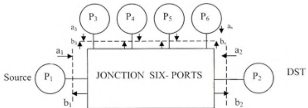
*Figure 1.2 Structure de la jonction six- port.*
