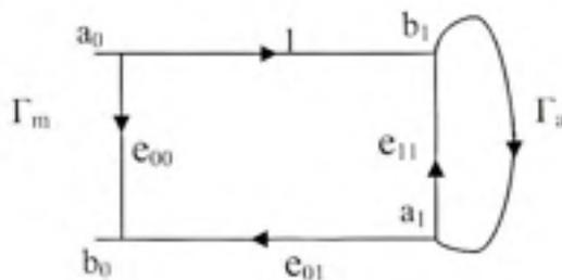
Figure 3.11 Graphe de fluence de la boîte d'erreur.
