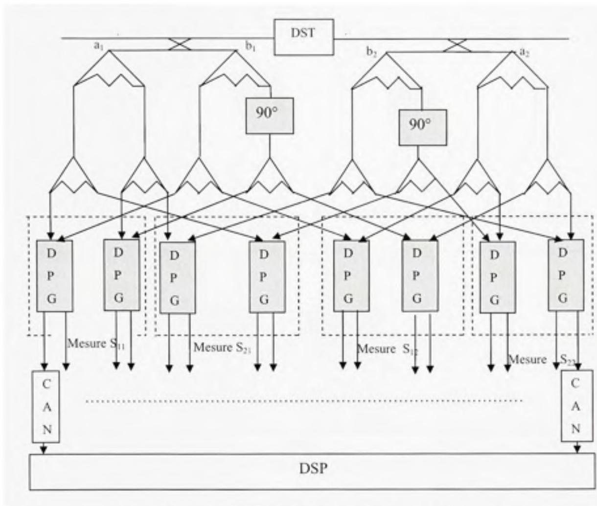
*Figure 4.4 Architecture n° 1 d'intégration des DPG aux SRFL.*
