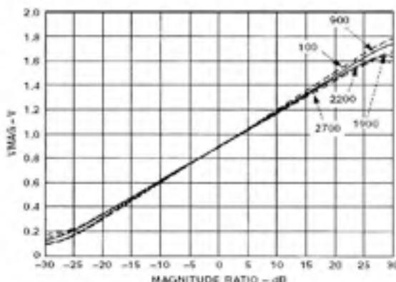
**Figure 2.3** Fonction de transfert en amplitude du DPG.
