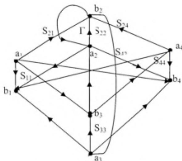
Figure 3.7 Graphe de fluence en utilisant des isolateurs.
