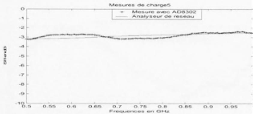
Figure 3.22 (a) Mesure de réflexion de charge5.
