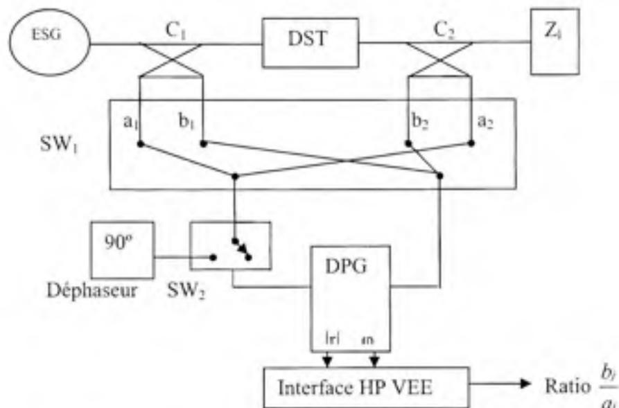
*Figure 3.1 Architecture simplifiée du banc de test.*
