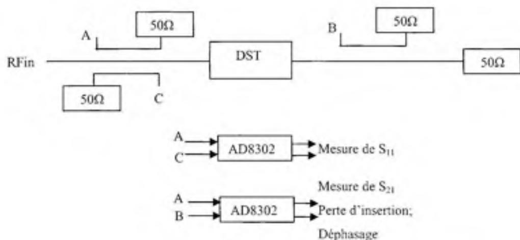
Figure 1.7 Exemple de topologie de mesure avec le AD8302.
