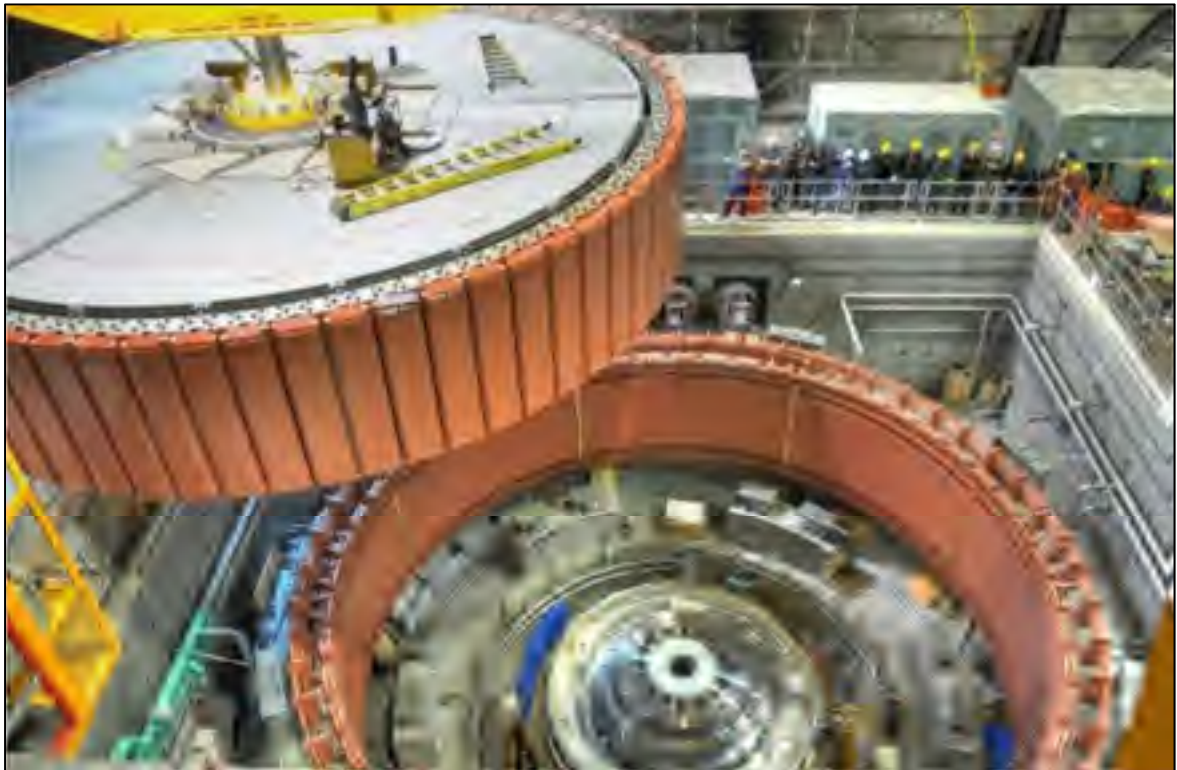
Figure 2.1 Alternateur hydroélectrique Source : Hydro-Québec
