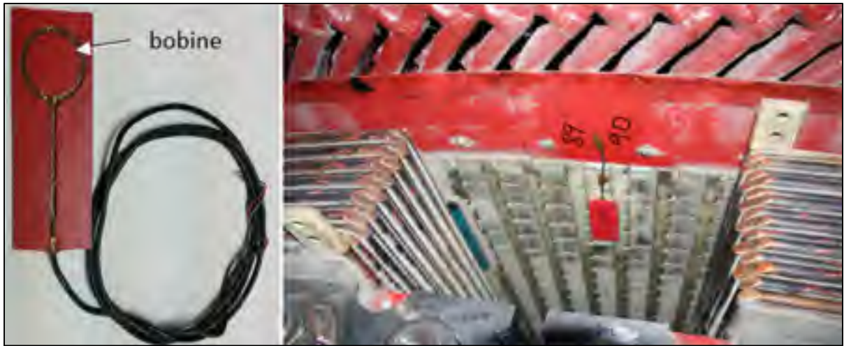
Figure 2.13 Capteur de flux circulaire installé dans l'entrefer
