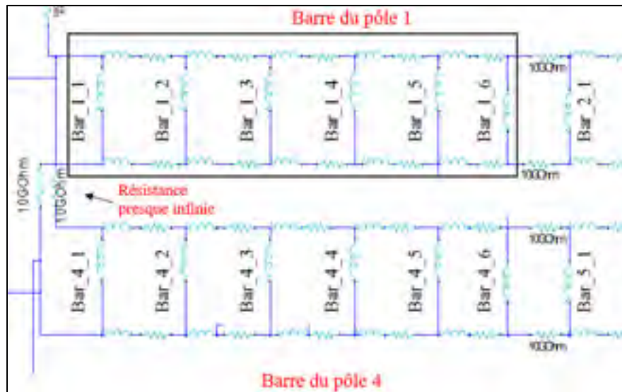
Figure 2.3 Circuit de connexion des barres d'amortisseur de LG1
