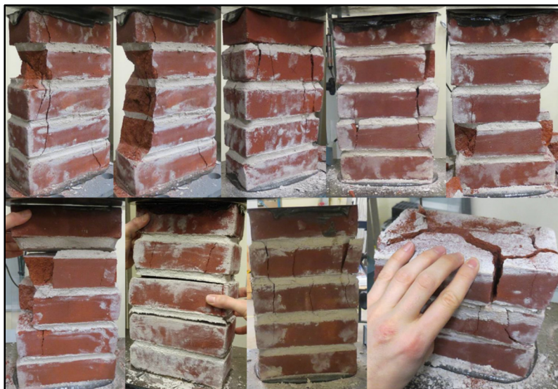
Figure 3.2 Échantillon de maçonnerie testés en compression
