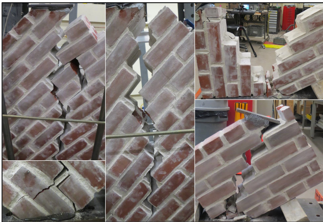
Figure 3.18 Exemples de ruptures obtenues pour les essais de traction diagonale
