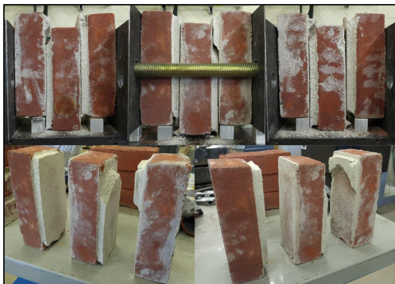
Figure 3.11 Spécimens de maçonnerie testés en cisaillement
