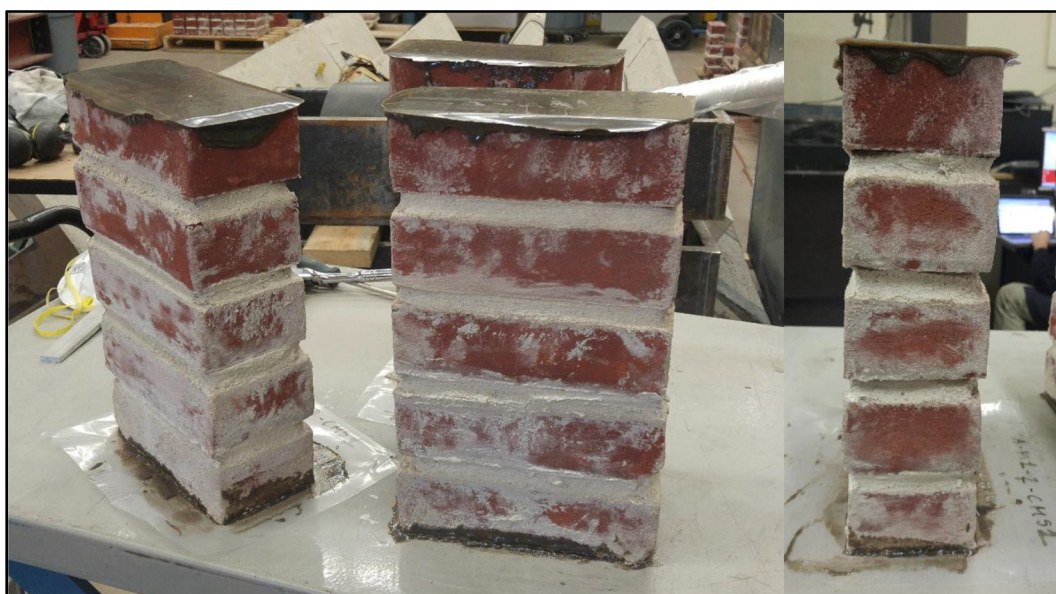
Figure 2.12 Échantillon de maçonnerie pour l'essai en compression
