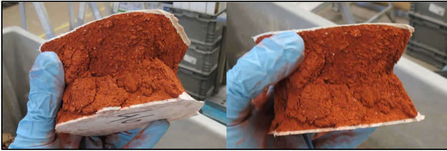
Figure 4.1 Éprouvettes de brique testées en compression
