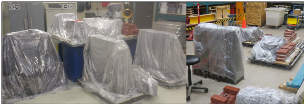
Figure 2.14 Spécimens de maçonnerie subissant une cure humide
