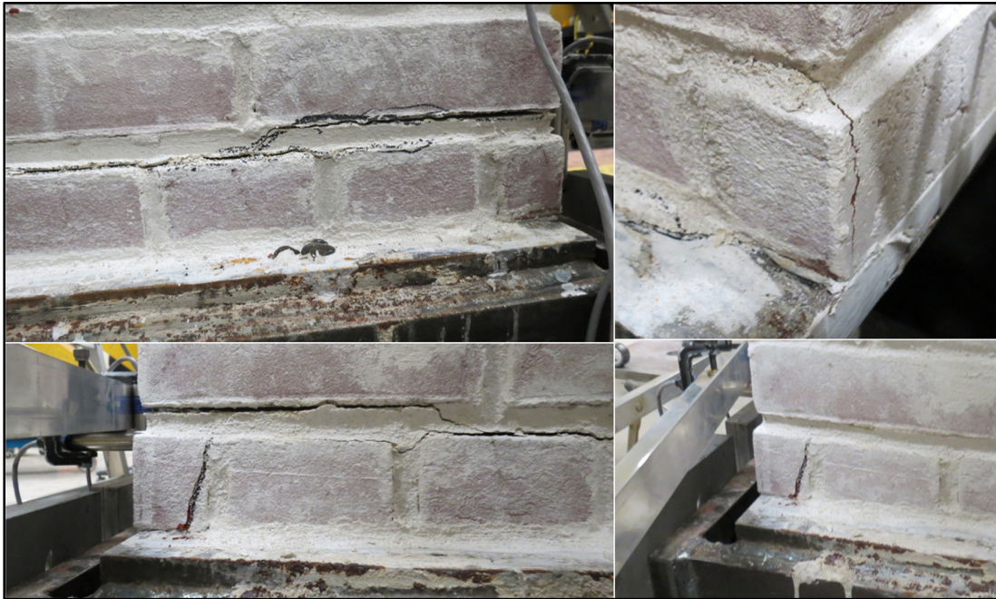
Figure 4.18 Exemples de fissures obtenues pour les essais de sollicitation cyclique
