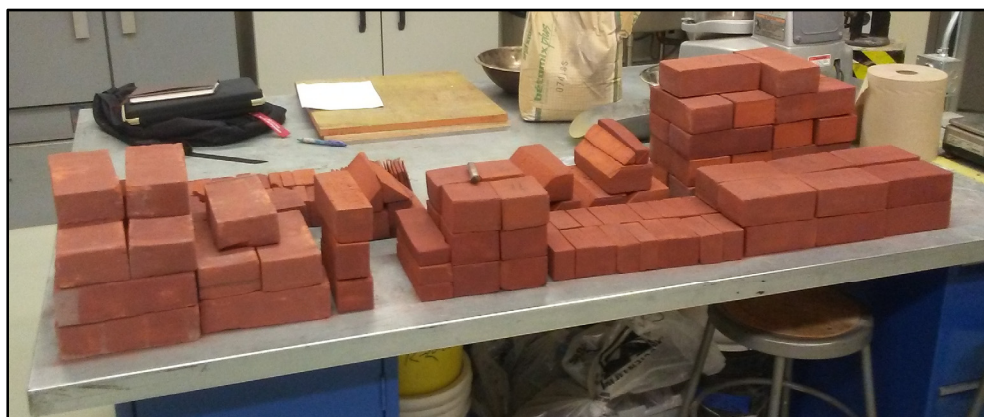
Figure 2.5 Briques taillées pour les murets
