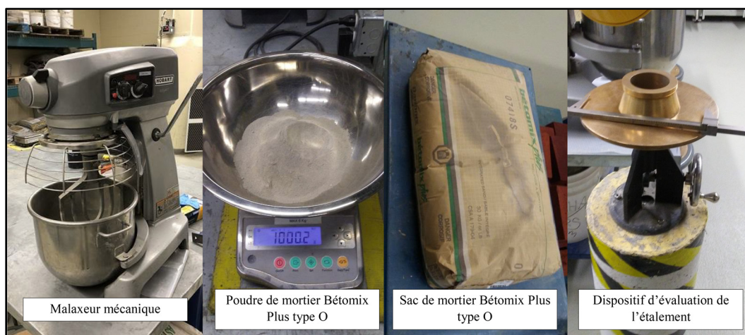
Figure 2.3 Dispositif utilisé pour la réalisation du mortier
