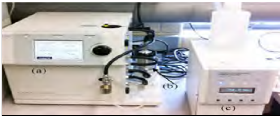
Figure 2.19 Le spectromètre SMPS constitué de : (a) classificateur électrostatique (modèle 3080, TSI inc.) (b) nano DMA (modèle 3085, TSI inc.) (c) CPC (modèle 3775, TSI inc.)
