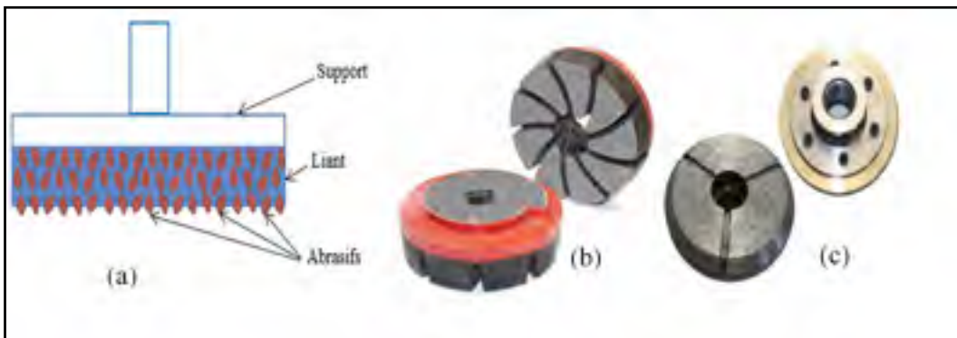
Figure 1.10 Outil de polissage rotatif (a) Schéma des constituants d'un outil abrasif de polissage (b) Outil avec liant en résine. Tiré de (ABRESSA, 2015a) (c) Outil avec liant métallique. Tiré de (ABRESSA, 2015b)
