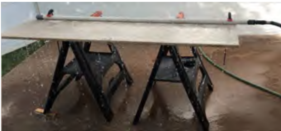
Figure 1.36 Méthode de mouillage appliquée directement sur la surface du comptoir en granit à polir. Tiré de (Johnson et al., 2017)
