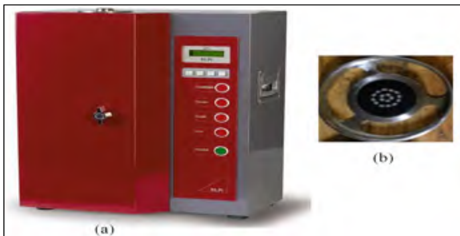
Figure 2.21 Machine de prélèvement et de classification des particules de poussière de quartz : (a) ELPI Classique (DEKATI Ltd) (b) Une des plaques d'impaction de l'ELPI équipée d'un substrat en carbone
