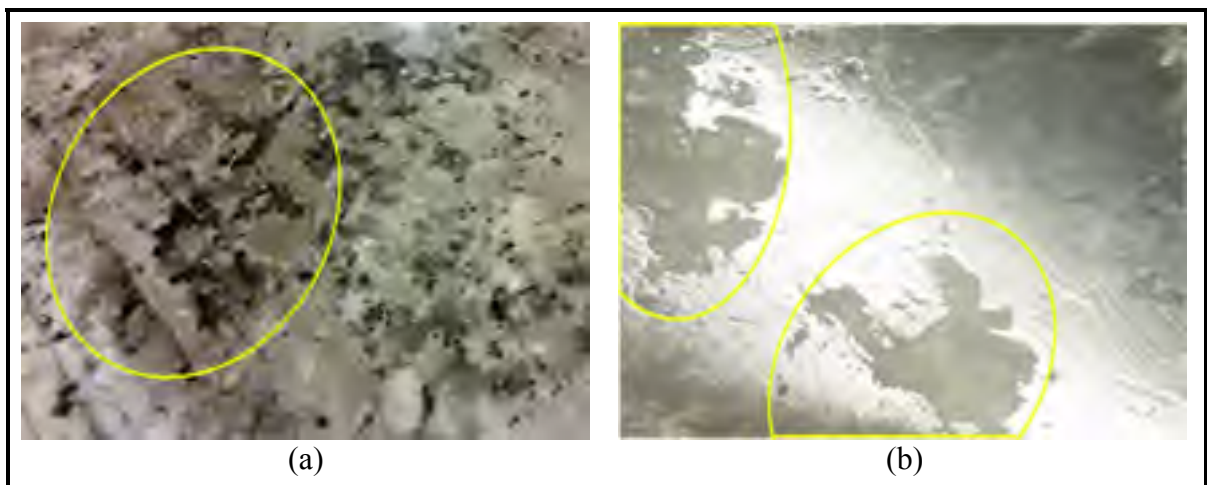
Figure 3.3 Défauts de surface, constatés dans la phase de finition, dus au frottement et à la surchauffe (a) Brûlure de surface (granit blanc) (b) Arrachement de matière (granit noir)
