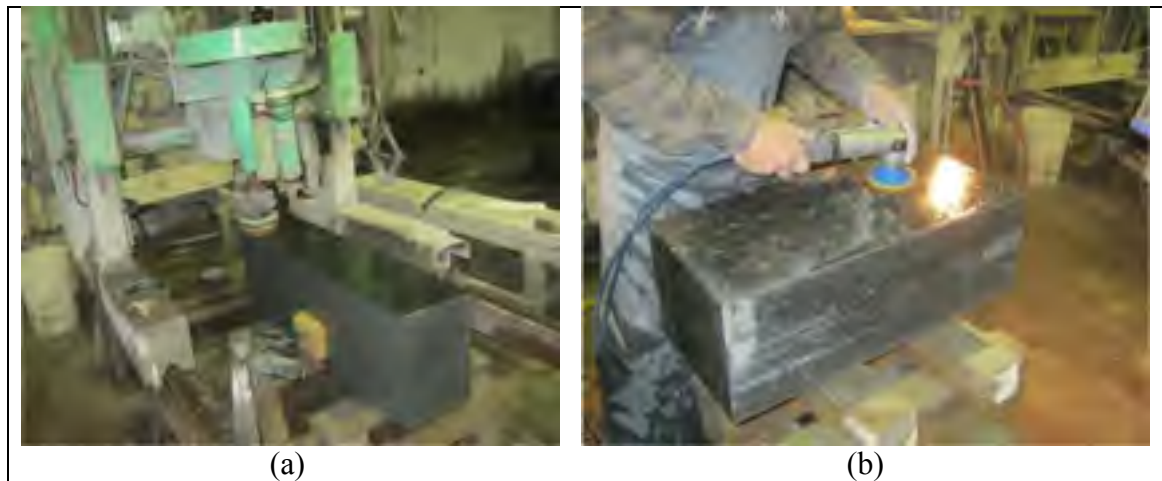
Figure 1.12 Polissage rotatif de granit (a) Polissage automatique (b) Polissage manuel. Tiré de (Migan, 2015)
