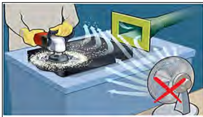
Figure 1.31 Ventilation locale et influence de flux d'air sur la captation. Tiré de (Goyer, Bahloul et Veillette, 2010)
