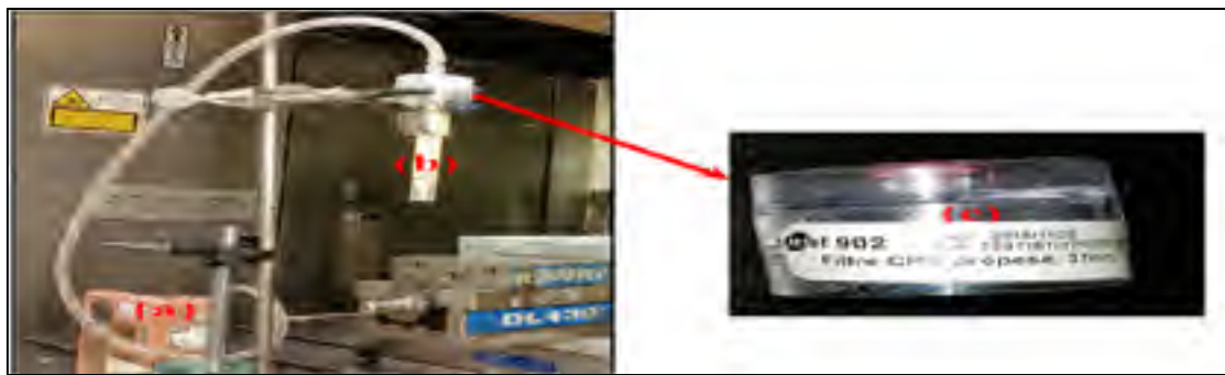
Figure 2.20 Dispositif d'échantillonnage de l'air de travail lors du polissage de granit sur la machine-outil : (a) Pompe (b) Cyclone (c) Cassette (fournie par l'IRSST)
