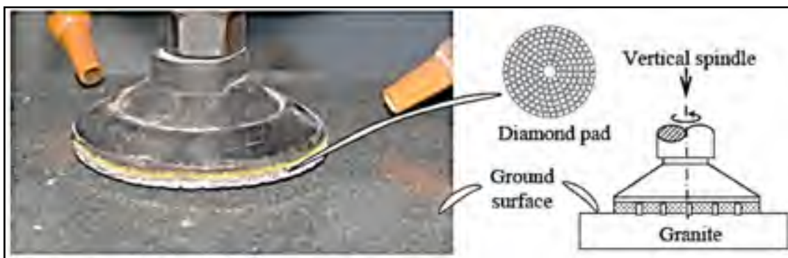
Figure 1.15 Outil rotatif de polissage de granit. Tiré de (Xu, Huang et Li, 2003)
