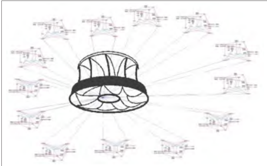
Figure 2.41 Modèle de fissuration complet
