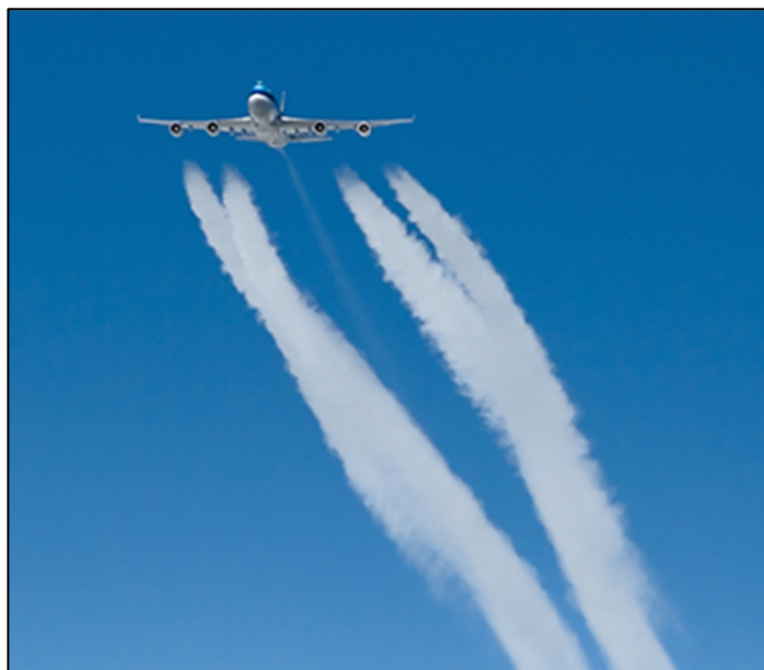
Figure 0.1 Formation d'une traînée de condensation dans le sillage d'un avion commercial
