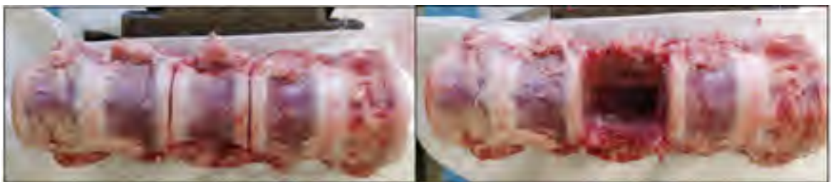
Figure 5.3 Corporectomie réalisée sur le corps vertébral antérieur central
