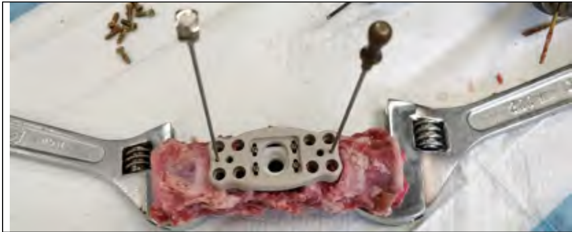
Figure 5.4 Broches orthopédiques de Kirschner maintenant le dispositif sur les vertèbres
