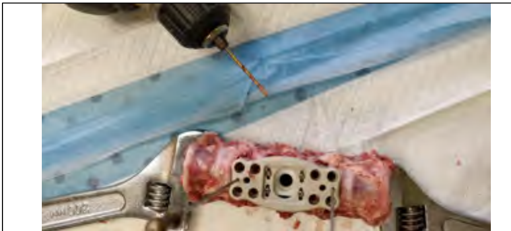
Figure 5.5 Trous percés dans les corps antérieurs aux endroits prévus sur la plaque
