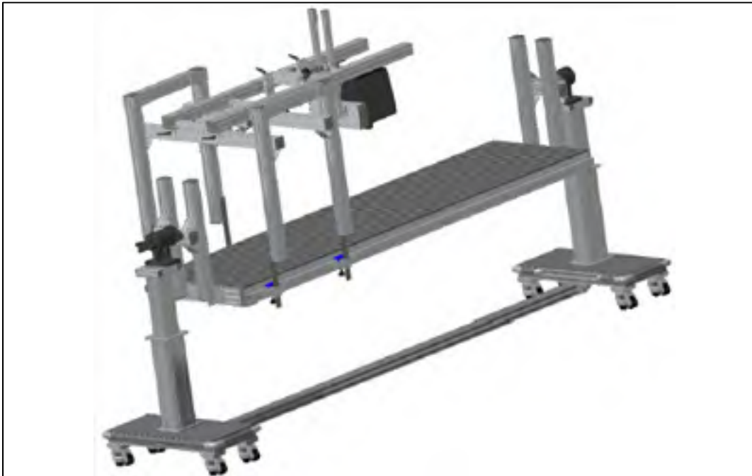
Figure 4.2 Version finale du banc d'essai avec impacteur installé par Francis Cliche Tirée de Cliche (2014, p. 99)
