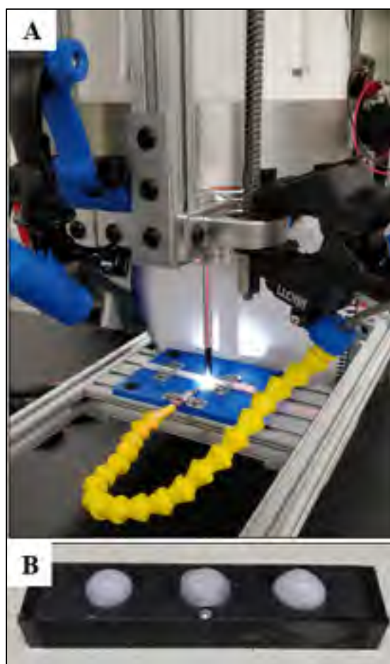
Figure 4.19 A) Montage expérimental des tests préliminaires sur moelle épinière synthétique, B) moule pour le substitut de moelle épinière en silicone
