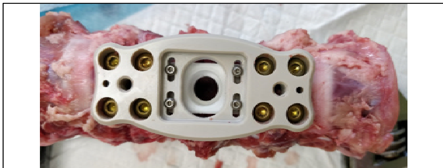
Figure 5.7 Dispositif fixé aux vertèbres grâce aux vis pour os spongieux
