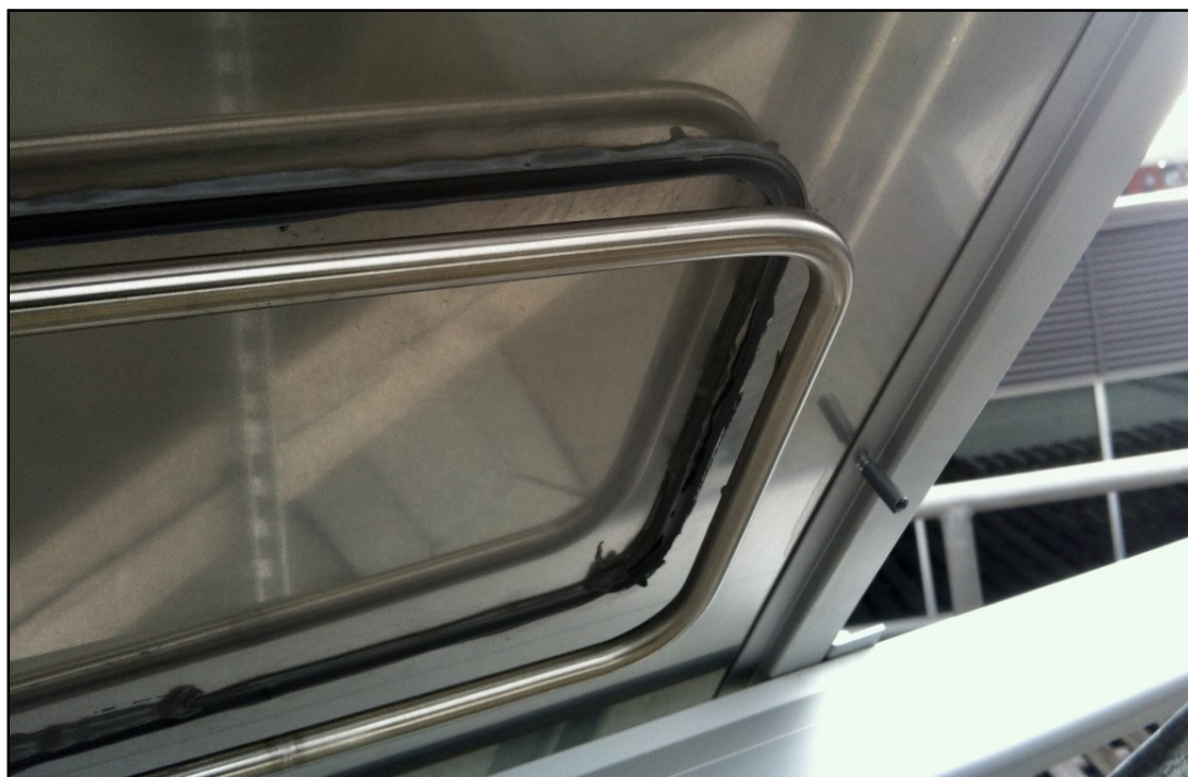
Figure 1.8 Problème de délaminage du serpentin
