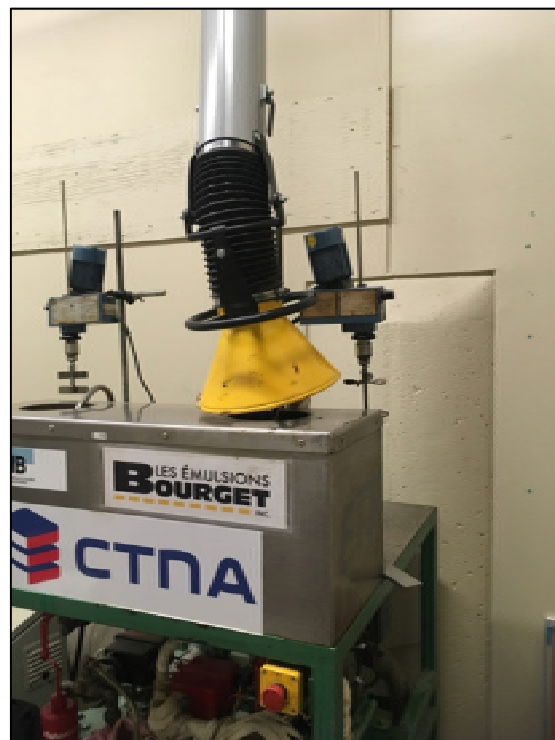
Figure A I-7 Ventilation de la benne à bitume
