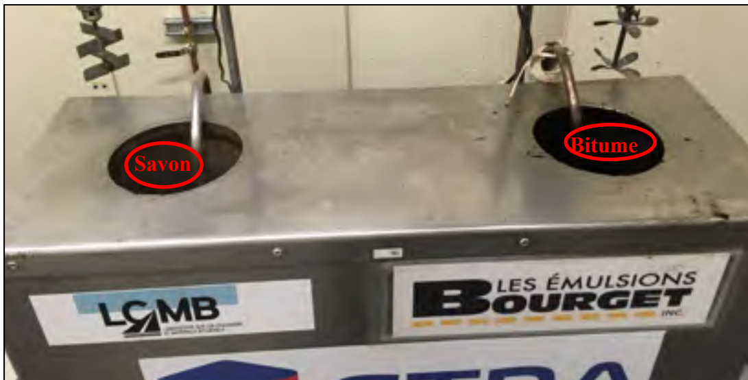
Figure A I-6 Benne à savon (gauche) et benne à bitume (droite)
