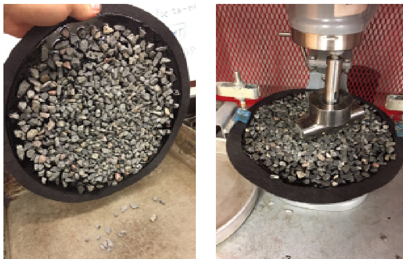
Figure 2.5 Fabrication de l'éprouvette pour l'essai de balayage : préparation des éprouvettes avant l'essai. – A) Enlèvement du surplus d'agrégats. B) Essai d'arrachement
