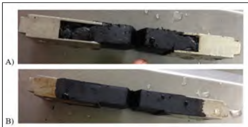
Figure 2.9 Exemple d'éprouvette DENT – A) Éprouvette avant 4 heures supplémentaires dans l'étuve à 60°C. B) Éprouvettes après 4 heures à 60°C
