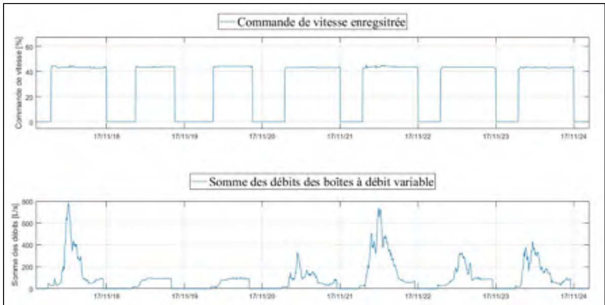
Figure 4.7 Variation de la commande de vitesse de ventilateur a) et de la somme des débits b) de l'UTA 804 18-24/11/2017
