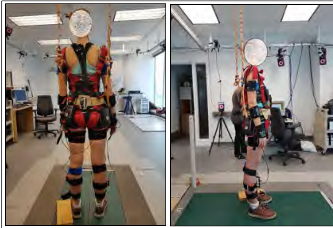
Figure 2.1 Participante dotée du système de capteurs inertiels, des plaques dotées de marqueurs réfléchissants ainsi que du harnais de sécurité
