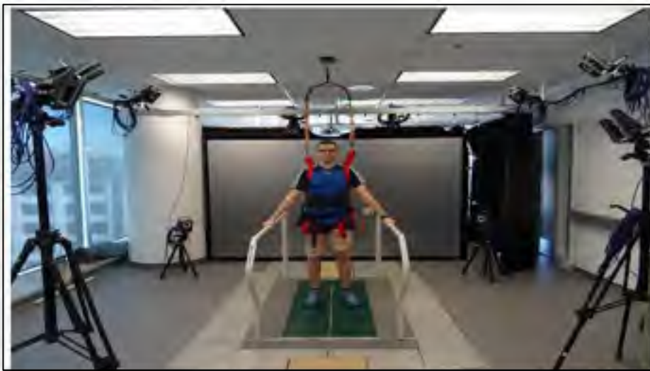
Figure 1.3 Tapis roulant AMTI à double voie ainsi que le système de caméra VICON du LIO (CRCHUM)
