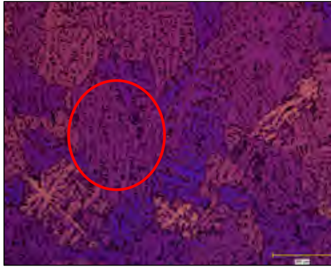
Figure 2.2 Taille de grain pour l'alliage 3 non Homogénéisé obtenue par le procédé conventionnel Coulage DC (85 micromètres au microscope optique polarisé)
