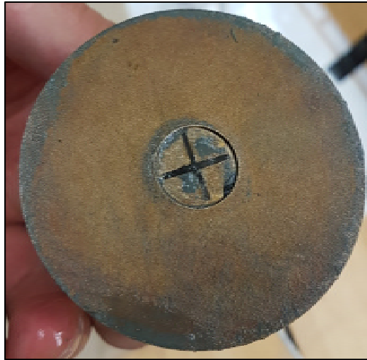
Figure 3.2 Assemblage de l'anneau dans la pierre poreuse avec une languette d'appuie
