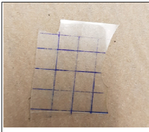
Figure 4.3 Échantillons prélevés sur une plaque de résine CY 192
