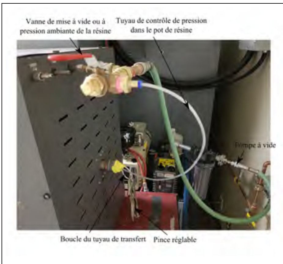
Figure 4.9 Montage de fabrication à l'arrière de l'étuve
