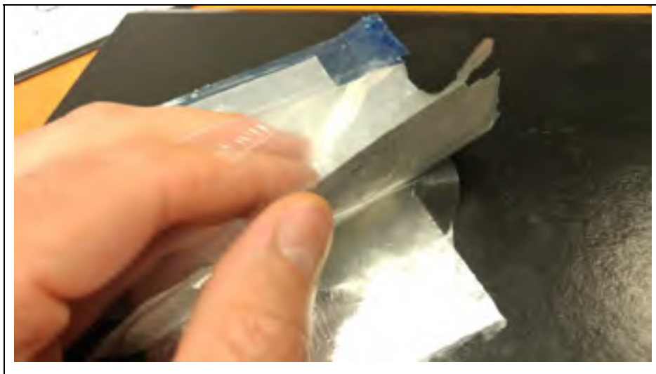
Figure 3.13 Délamination entre l'électrode d'aluminium et le film de polypropylène du condensateur LAM_06_D
