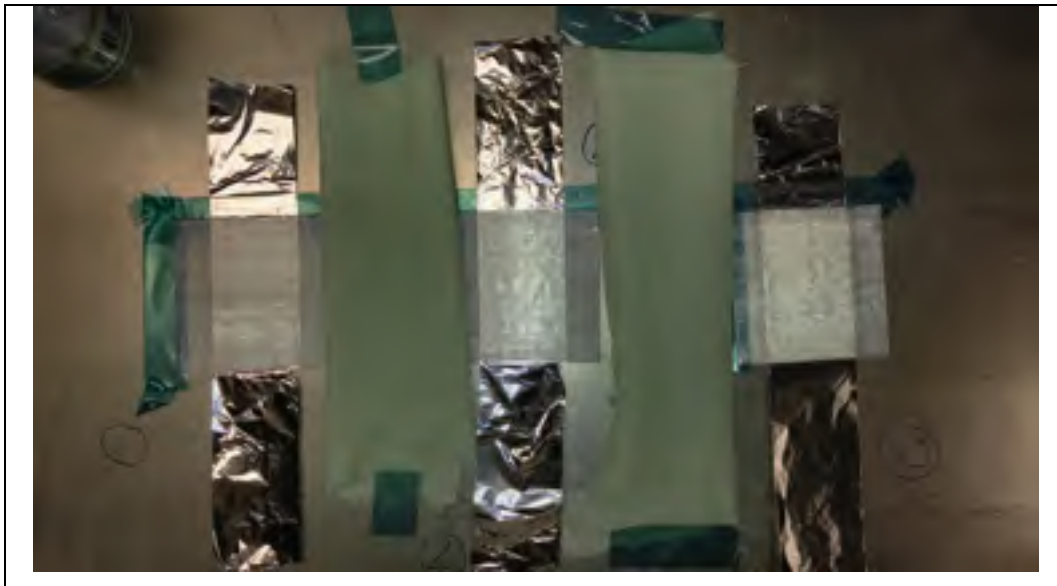
Figure-A I-1 Condensateurs de la série LAM_04 en Thinpreg 402, avant cuisson
