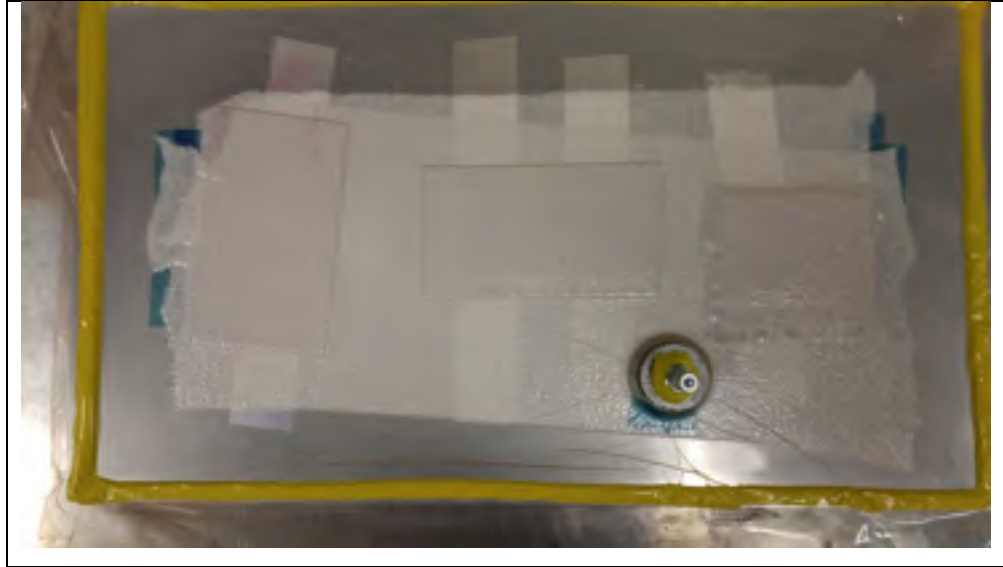
Figure 3.8 Moulage de condensateurs plats FM300 lors d'un essai de tenu du vide du sac
