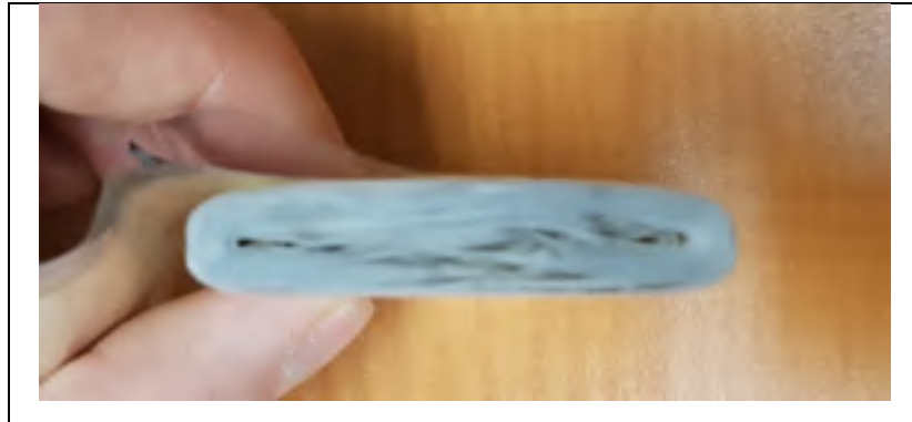
Figure 2.2 Photo d'une bobine prélevée dans une partie active
