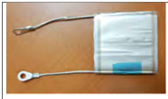
Figure 4.5 Enroulement capacitif avec ses connexions avant imprégnation
