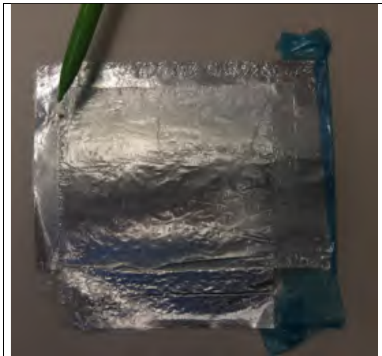
Figure 3.15 Condensateur LAM_06_B après claquage. La pointe du stylo indique le site du claquage.
