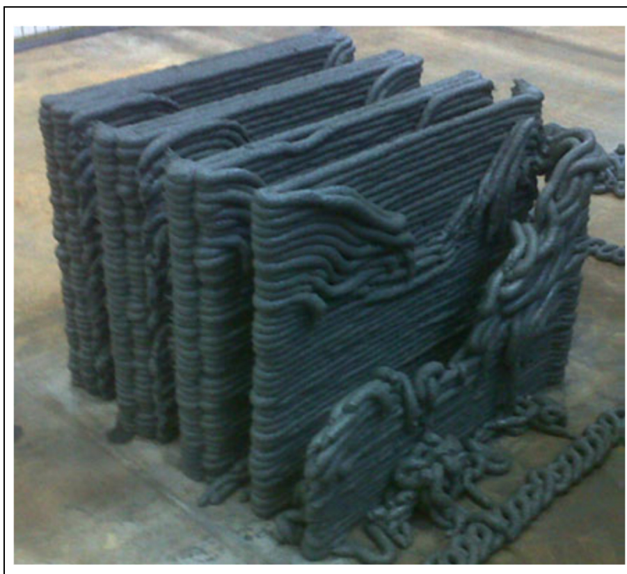
Figure 1.19 Exemple de l'imprimabilité d'un mélange de mortier avec un seuil d'écoulement de 0,55 kPa selon le nombre de filaments imprimés Tirée de Le et al. (2012)
