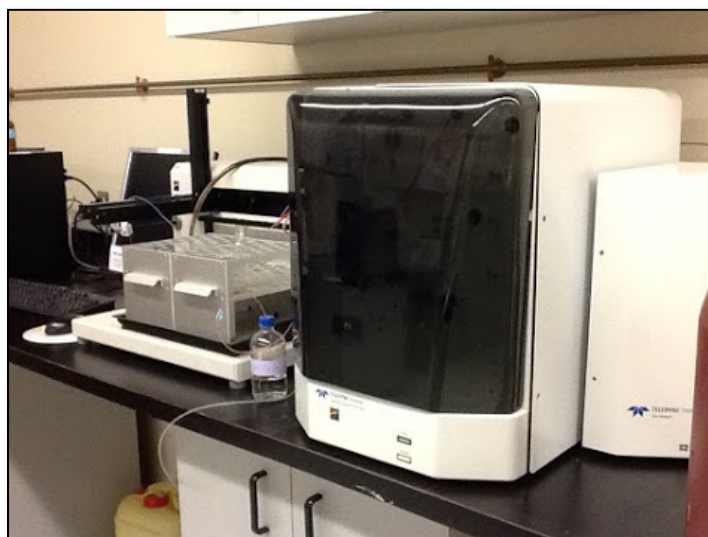
Figure 2.6 : Analyseur de marque TELEDYNE TEKMAR, modèle Apollo 9000
