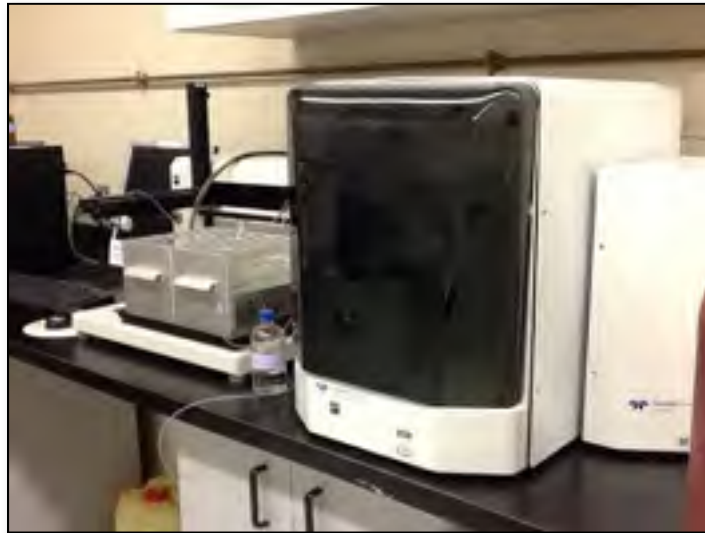
Figure 2.6 : Analyseur de marque TELEDYNE TEKMAR, modèle Apollo 9000
