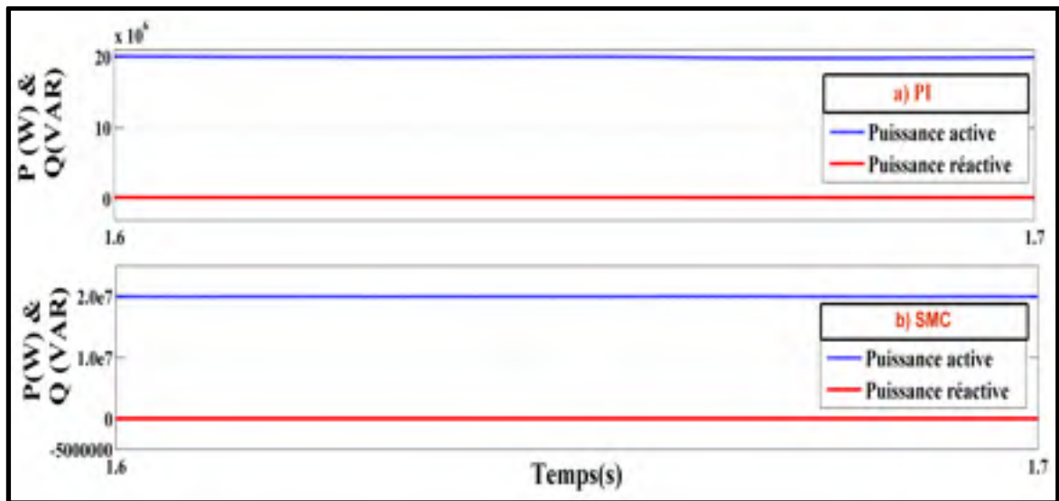
Figure 5.23 Les formes d'ondes de la puissance active et réactive côté onshore: a) Contrôleur PI, b) Contrôleur SM
