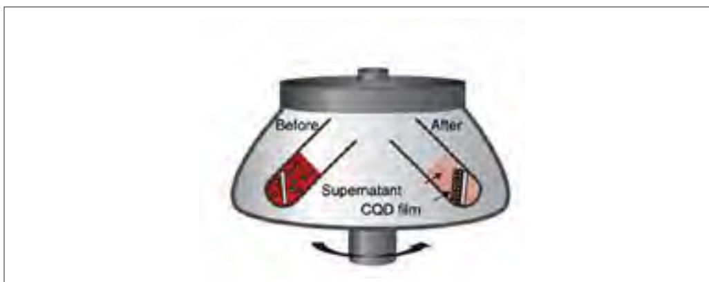
Figure 1.1: Mécanisme de centrifugation pour l'obtention des films de PQC (Kim et al, 2015)
