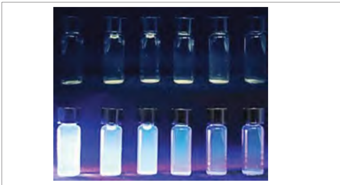
Figure 3.9: Diminution visuelle de l'intensité de la luminescence bleue des PQC
