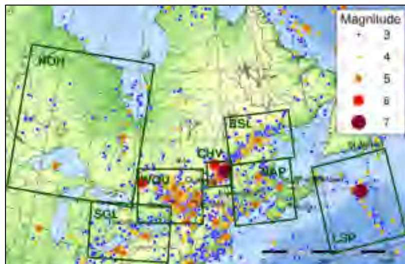
Figure 1.2 Localisation des zones de sismicité au Québec Adaptée de RNC; Ressources Naturelles Canada (2018a)
