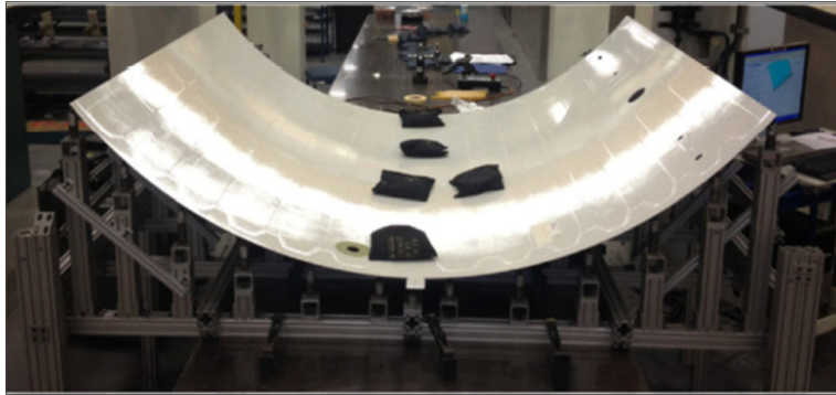
Figure 0.4 La pièce non rigide maintenue par des montages d'inspection et des charges appliquées (sacs de sable) (G. Abenhaim et al., 2015)
