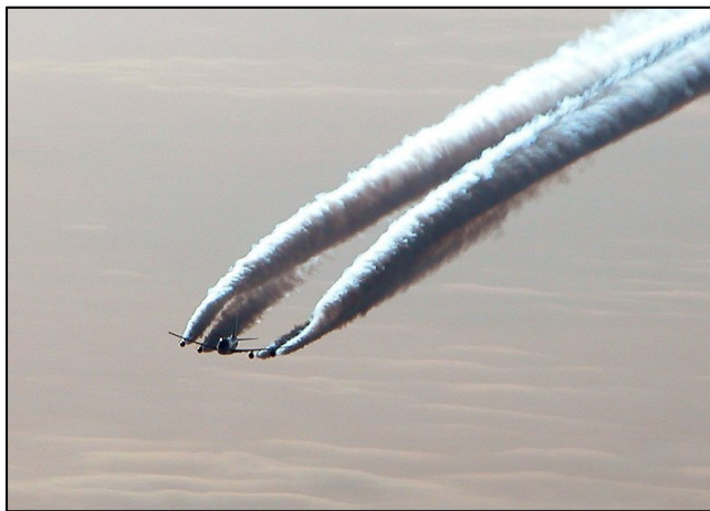
Figure 4.1: Traînée d'un Boeing 747 évoluant sous l'effet du tourbillon de sillage
