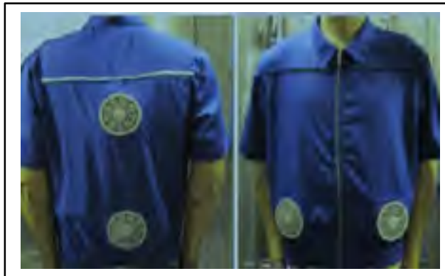
Figure 1-3 Veste à circulation d'air Tiré de Mengmeng et al. (2013)
