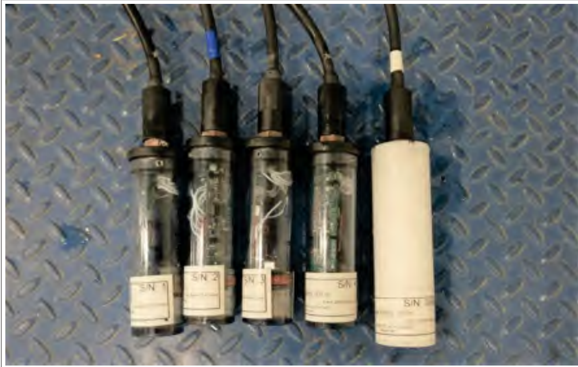
Figure 3.2 Quatre balises RBS et une balise TLT
