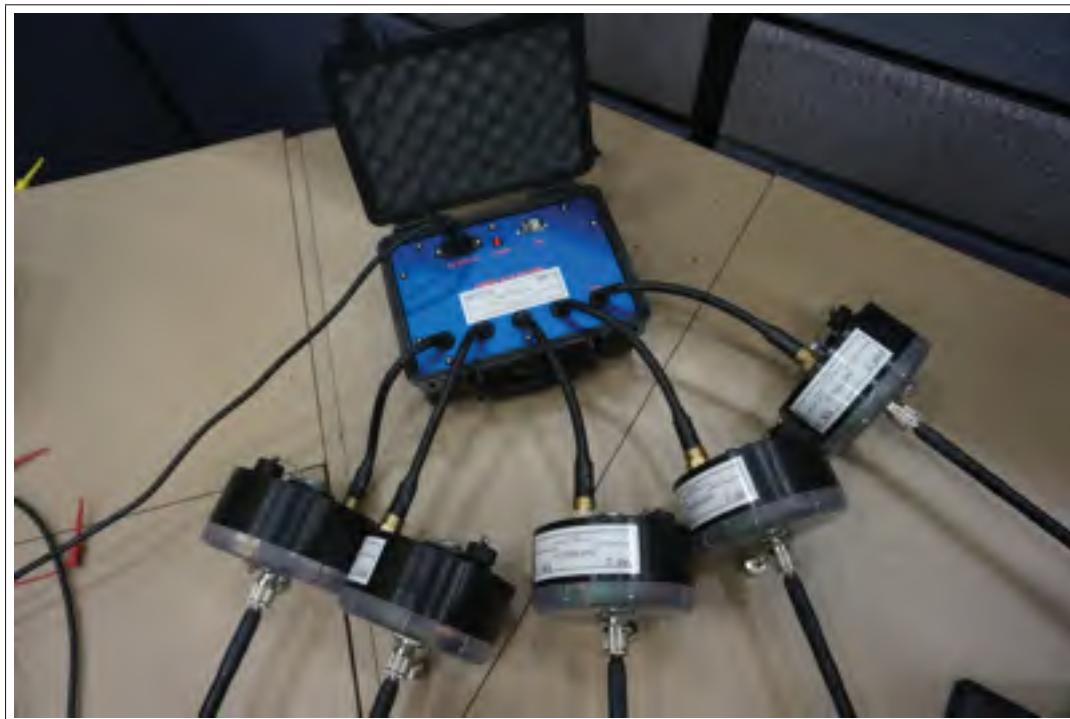
Figure 3.3 Chargeur et cinq modules FRF
