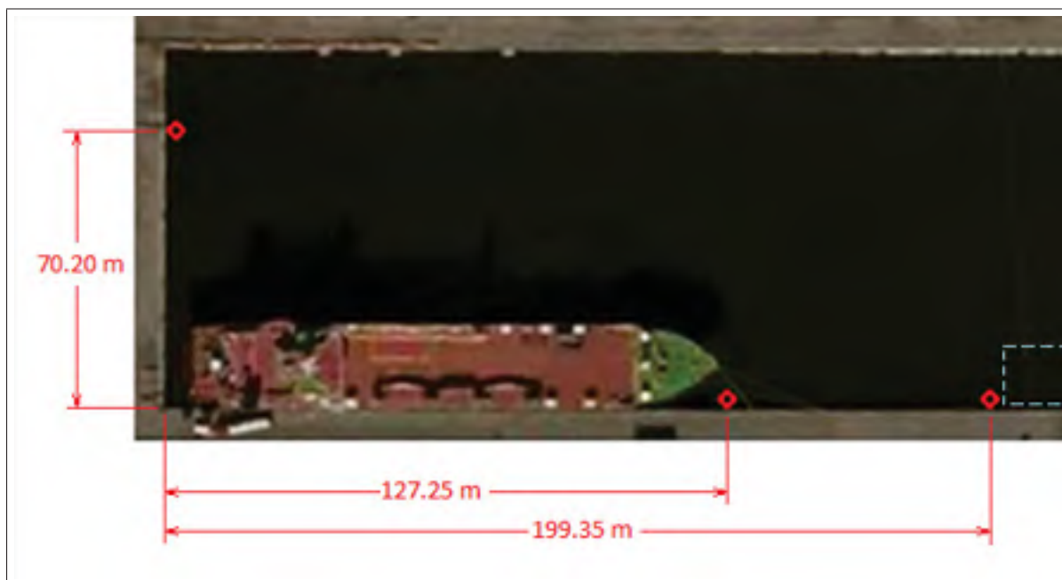
Figure 5.5 Positions des balises RBS pour le test en environnement réel
