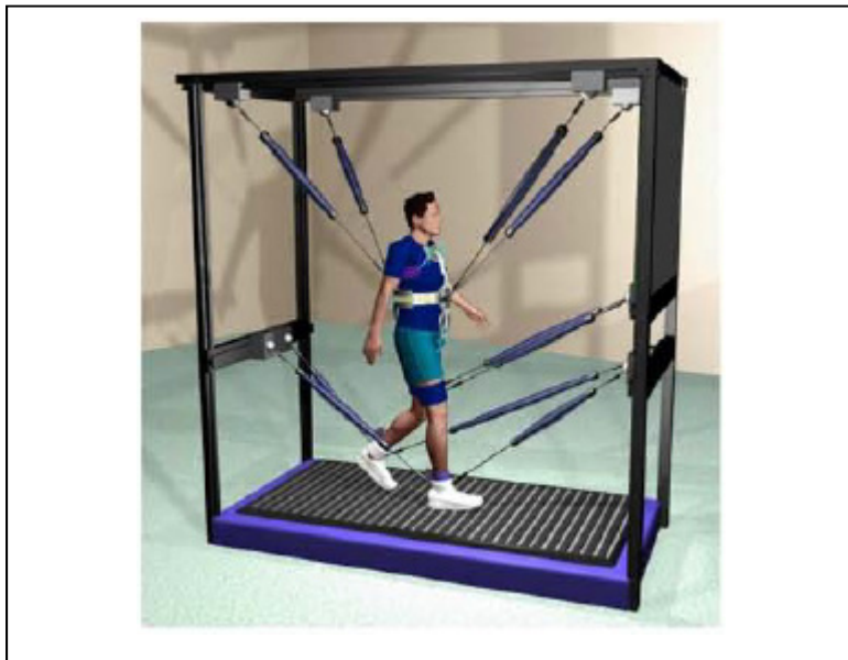
Figure 1.1 Structure mécanique du SMART-STRING Tirée de Surdilovic (2007)
