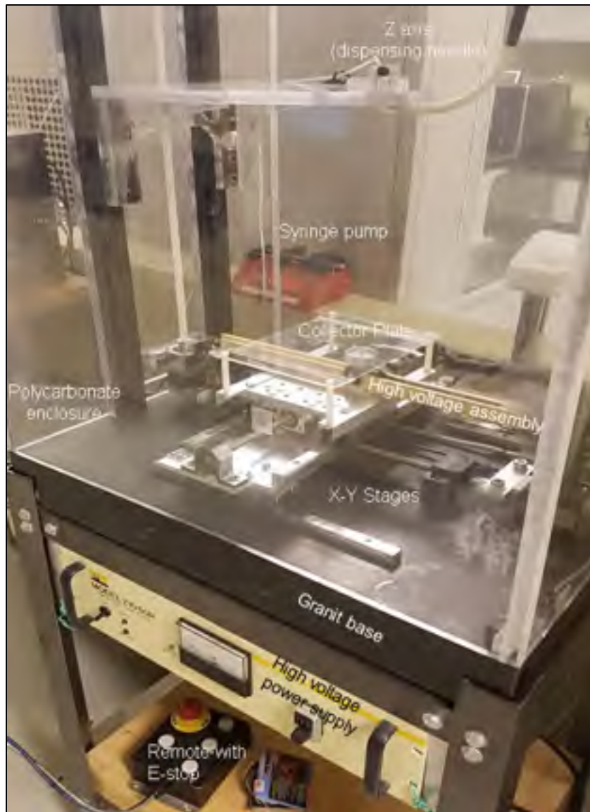
Figure 2.8 : Actual test bench
