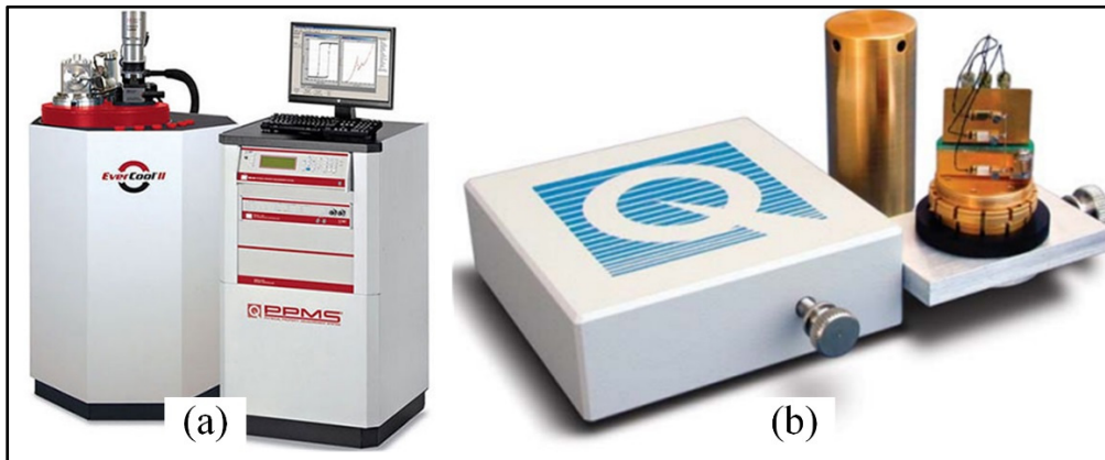
Figure 3.8 Équipements de caractérisation thermique : (a) Système de mesure de propriétés physiques et (b) configuration de transferts thermiques
