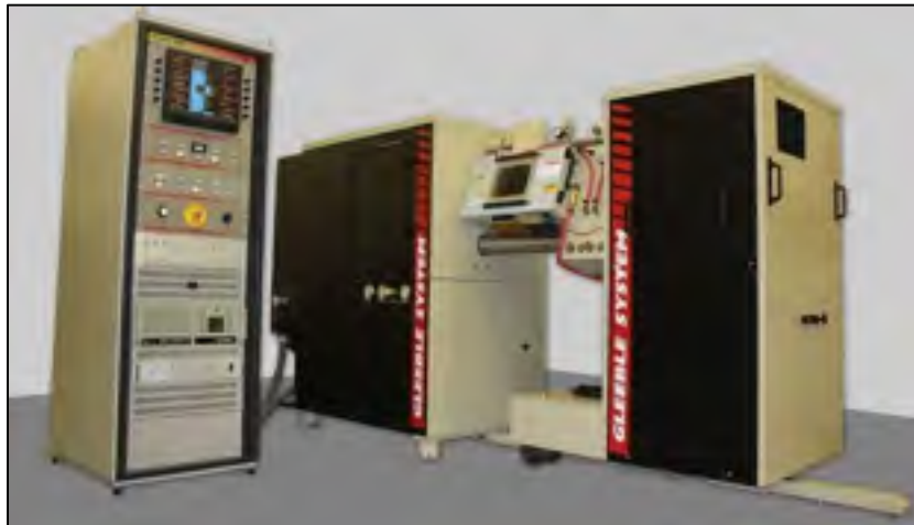
Figure 2.2 Simulateur de compression à chaud Gleeble-3800 (DSI, 2010)
