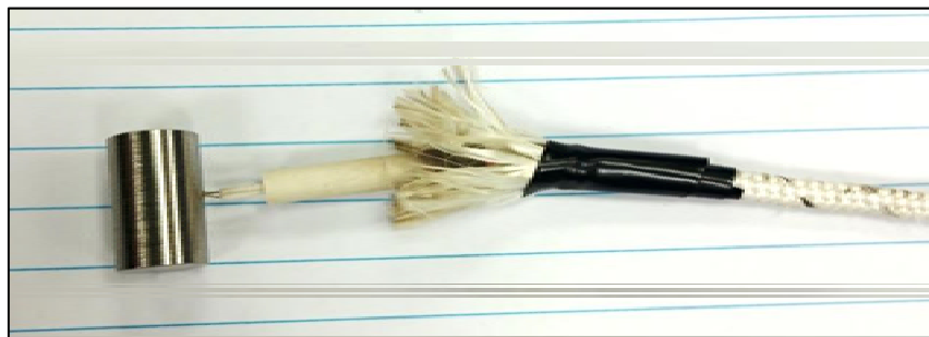
Figure 2.6 Échantillon instrumenté, avec gaines protectrices en alumine et fibre de verre autour des fils de thermocouples
