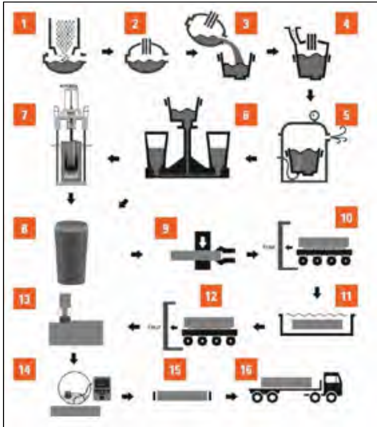
Figure 1.1 Élaboration de l'acier de seconde fusion chez Finkl Steel® (Sorel Forge, 2013)
