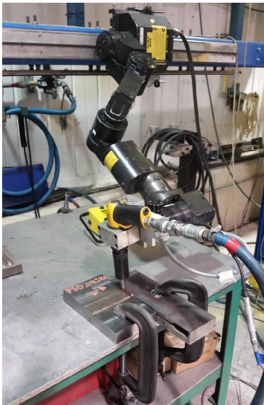
Figure 2.3 Montage pour l'opération de martelage
