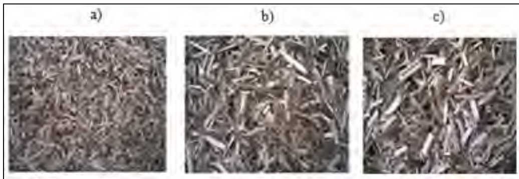
Figure 1.17 Chènevotte de finition (a), chènevotte fibrée pour dalle (b) et chènevotte standard pour isolation (c) ; Tirée de Fruchard (2017, p.03)
