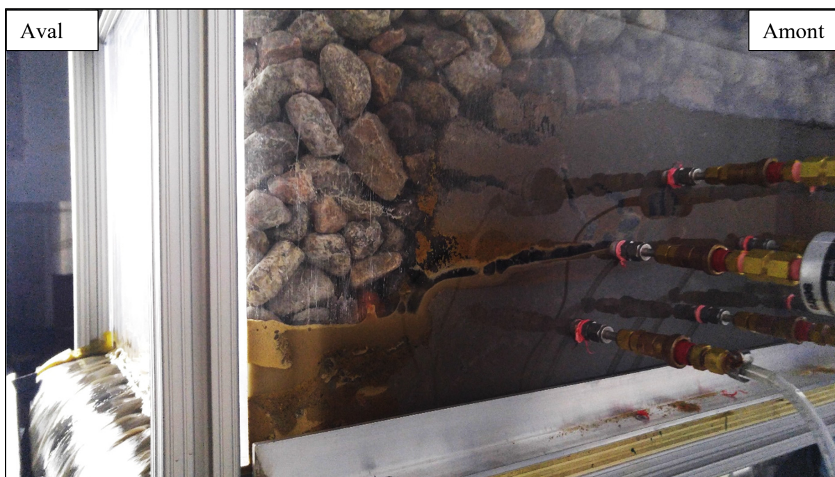
Figure 3.6 Formation d'un renard, côté aval à l'arrière du montage essai n° 2
