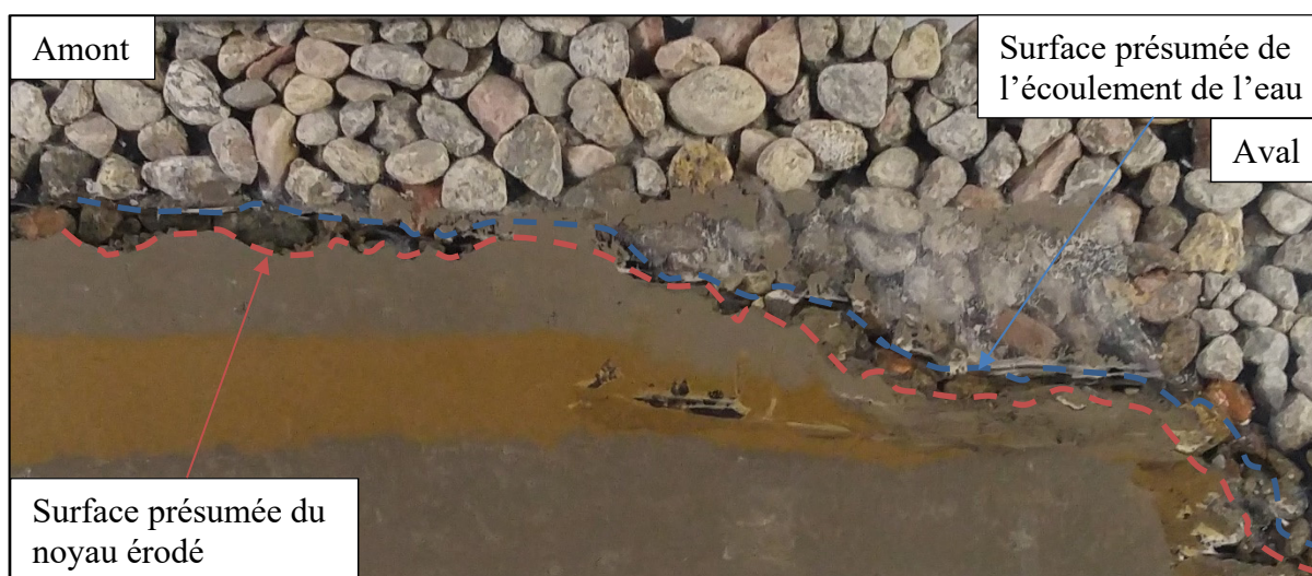
Figure 3.8 Forme finale du noyau érodé, avant du montage essai n° 2
