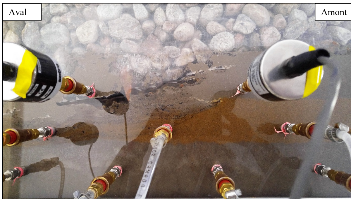
Figure 3.7 Érosion du till parallèlement à l'écoulement de l'eau, côté aval à l'arrière du montage essai n° 2
