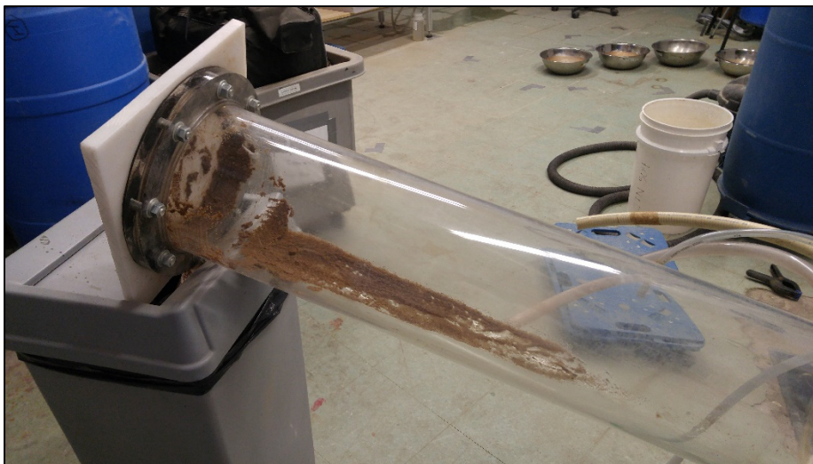
Figure 2.16 Nettoyage d'une colonne de sédimentation
